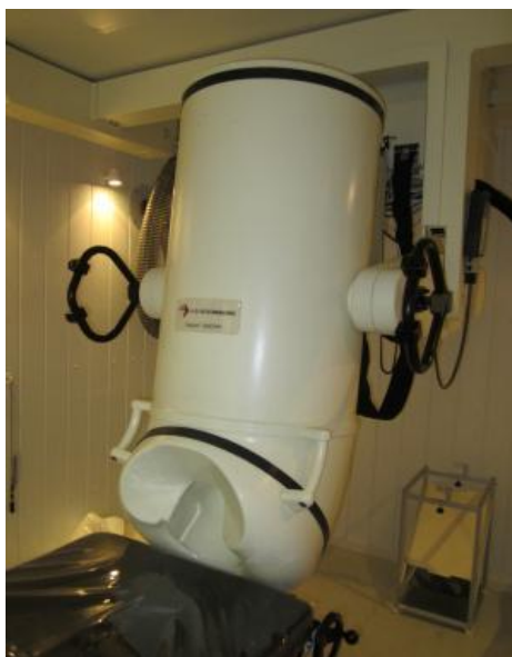
Σχήμα 3.1 Το σύστημα μαγνητοεγκεφαλογραφικής καταγραφής 4-D Neuroimaging Magnes 3600WH [3.12].
