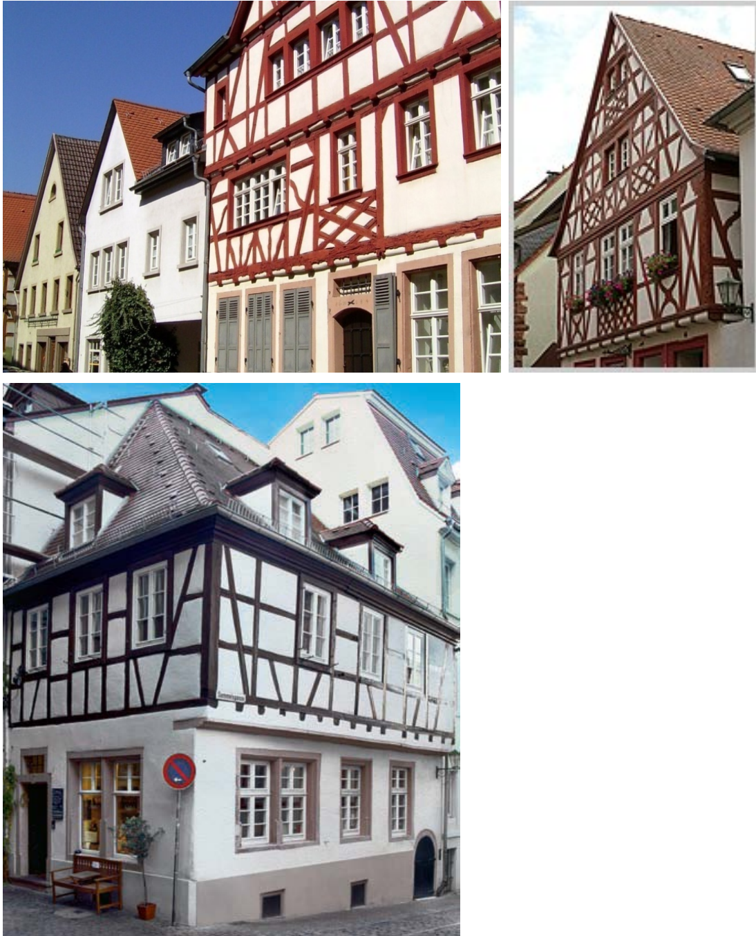
Εικ. 44 Κτίρια με σύμμικτη κατασκευή πετράς, ξύλου και πηλού
