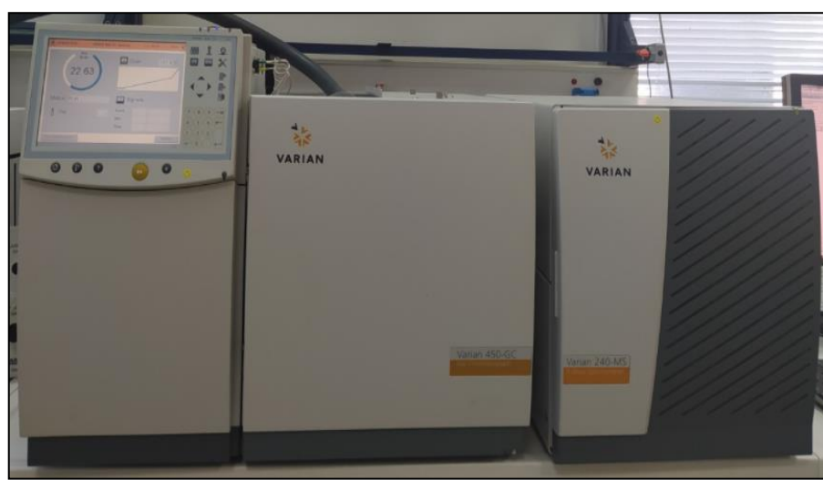
Εικόνα 6: Διάταξη αέριου χρωματογράφου-φασματομέτρου μάζας GC-MS
