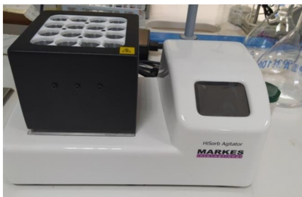
Εικόνα 7: Μηχάνημα θέρμανσης για τη διεξαγωγή πειραμάτων στους 50 °C
