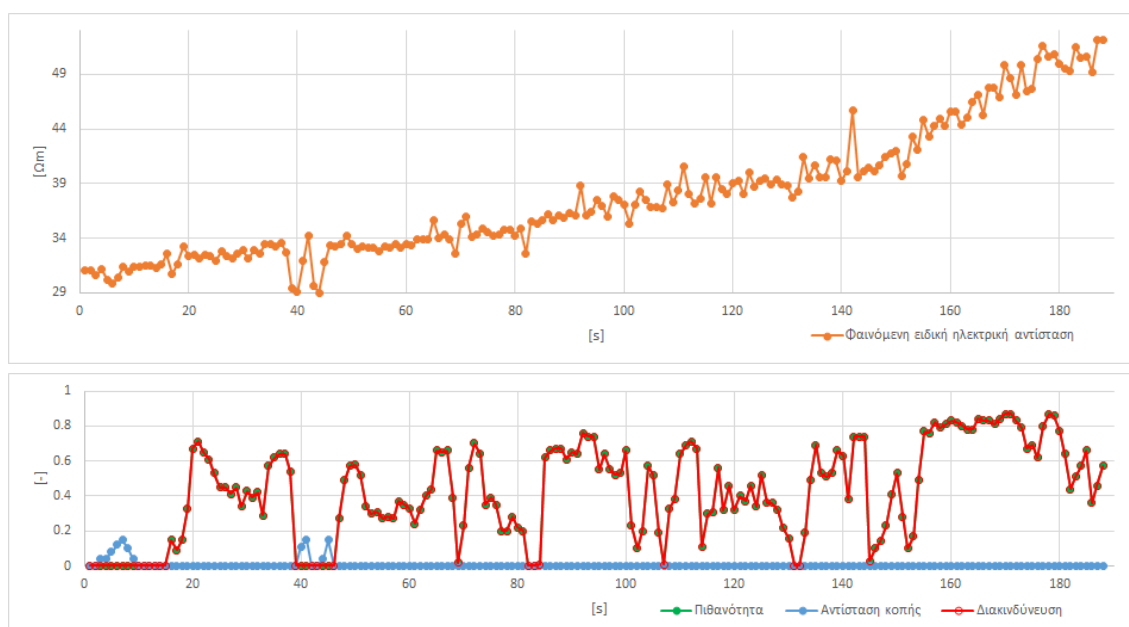
Σχήμα 4.17: Καταγραφή ειδικής ηλεκτρικής αντίστασης (επάνω) για το πάσο 25R0 όπως αποτυπώνεται στο Σχήμα 4.15 και παράμετροι διακινδύνευσης (κάτω).
