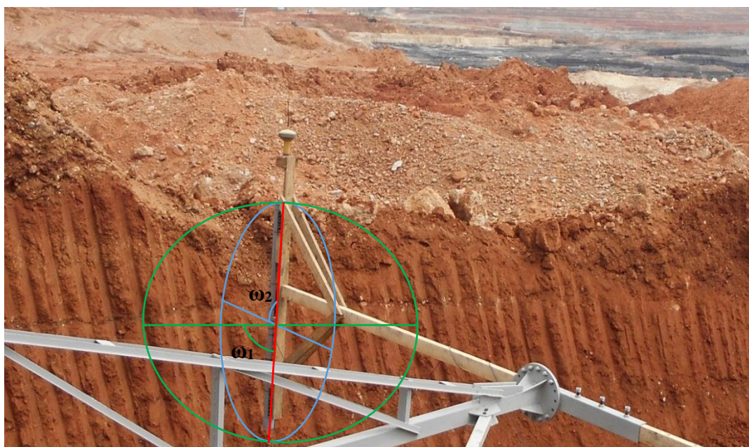
Σχήμα 4.27: Γωνίες διεύθυνσης \omega_1 και \omega_2 της ενόργανης διάταξης με τις δύο επιφάνειες κάθετα στην επιφάνεια της γης.
