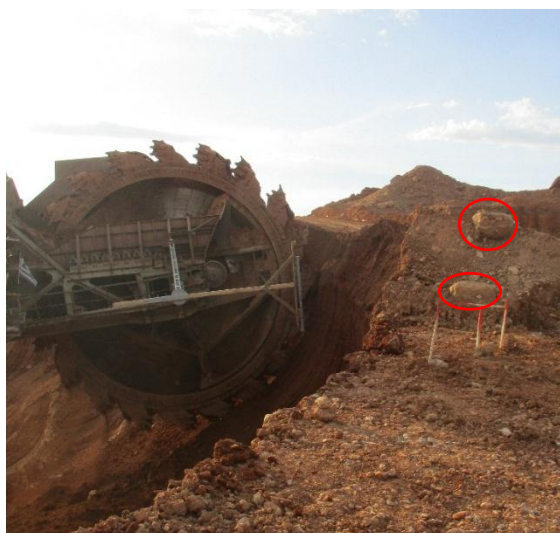
Σχήμα 4.13: Η θέση των σκληρών (πάσσαλοι) στη βαθμίδα κατά την εκσκαφή.
