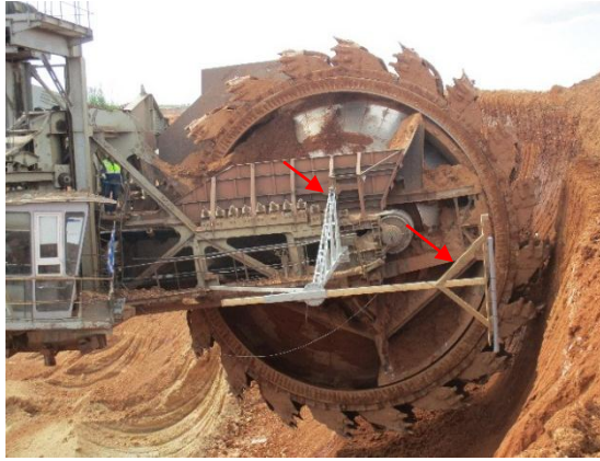
Σχήμα 1.1: Εκσκαφέας καδοτροχού του οίκου Takraf, μαζί με τον βραχίονα και τις μετρητικές διατάξεις (δέκτης GPS και μετρητική διάταξη τύπου CMD-2, κόκκινα βέλη)
