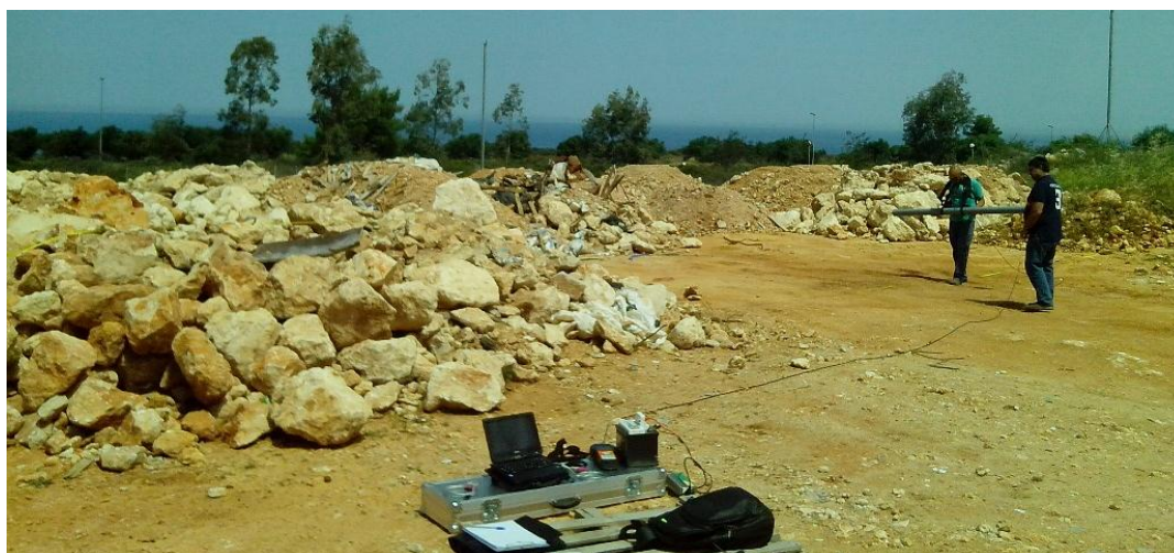
Σχήμα 4.19: Μετρητική διάταξη τύπου CMD-2 μαζί με το κάλυμμα, κατά τη διάρκεια διασκόπησης.
