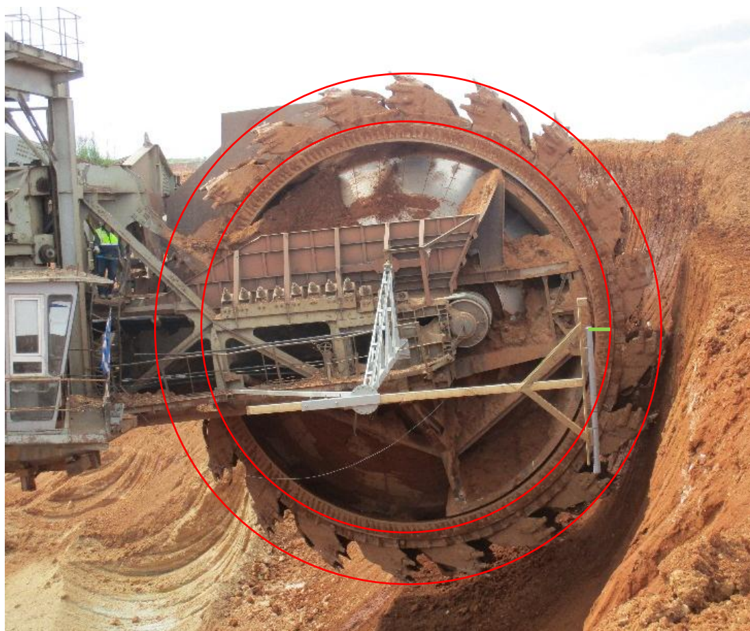
Σχήμα 4.29: Στεφάνη καδοτροχού (μικρός κύκλος), δόντια καδοτροχού (μεγάλος κύκλος) και απόσταση διάταξης από την προβολή της στεφάνης (πράσινο). Η ρύθμιση πραγματοποιείται με τον μεταλλικό βραχίονα.
