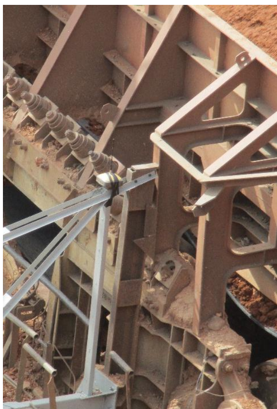
Σχήμα 4.11: Νέα θέση του δέκτη του GPS μετά την αστοχία του στηρίγματος.
