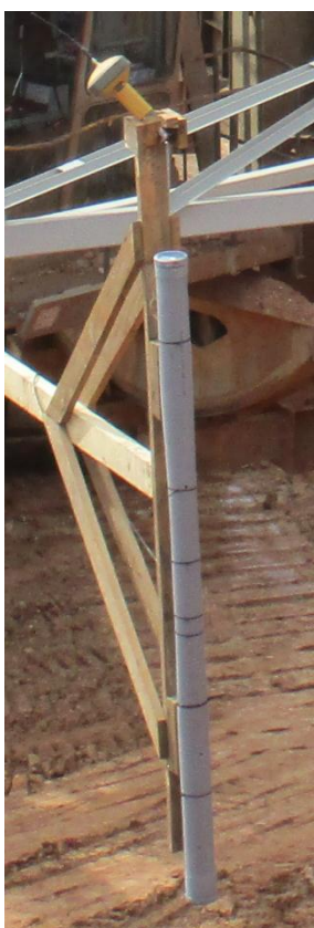
Σχήμα 4.10: Διάταξη τύπου CMD-2 εντός του προστατευτικού καλύμματος και της α-στοχία βάσης του δέκτη του GPS.
