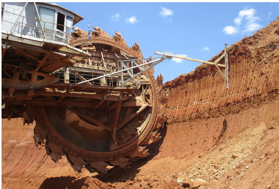
Σχήμα 4.9: Στήριγμα διατάξεων τοποθετημένο πάνω στον βραχίονα του εκσκαφέα. Διακρίνεται επίσης η μικρή απόσταση της διάταξης από το πρανές.
