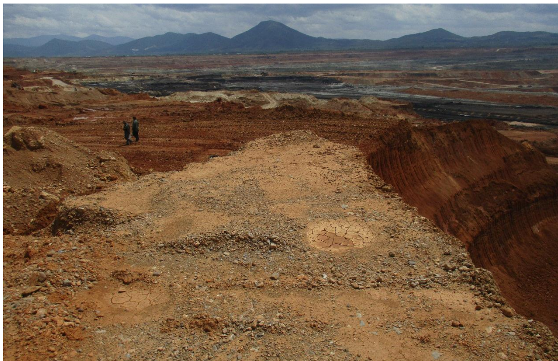
Σχήμα 4.28: Άποψη της γεωμετρικής μορφής του block εκμετάλλευσης στην οποία διακρίνεται η ακανόνιστη μορφή του δαπέδου της βαθμίδας και η «γεωμετρική» μορφή του μετώπου.
