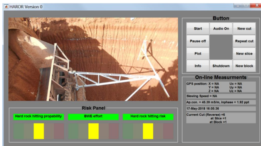
Σχήμα 4.6: Διεπαφή ανθρώπου υπολογιστή μαζί με κατάλληλες προειδοποιήσεις (Risk Panel), σε περίπτωση που υψηλές τιμές παραμένουν για πάνω από 5s αναδύεται ξεχωριστό μήνυμα. Επίσης στην εικόνα της κάμερας φαίνεται το μέτωπο εξόρυξης με το στήριγμα και τη μετρητική διάταξη.
