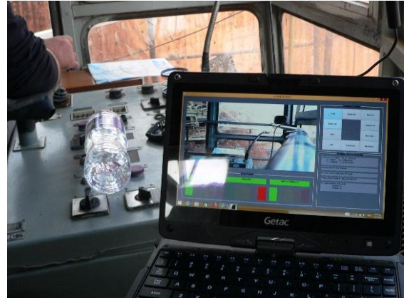
Σχήμα 1.2: Θάλαμος χειρισμού του εκσκαφέα και υπολογιστής για την καθοδήγηση του χειριστή.
