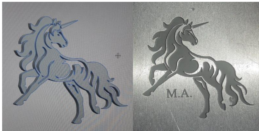
Σχήμα 2.2: 3D σχέδιο CAD και εφαρμογή χάραξης με laser σε αλουμίνιο
