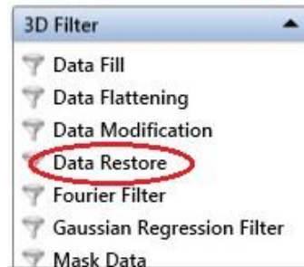
Σχήμα 3.26: Επιλογή του «Data Restore» από το «3D Filter»
