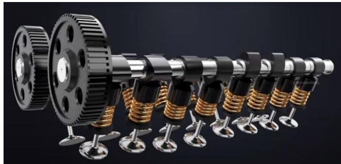
Εικόνα 2.3.6: Οι Δύο εκκεντροφόροι άξονες μαζί με τις βαλβίδες εισαγωγής και εξαγωγής.
