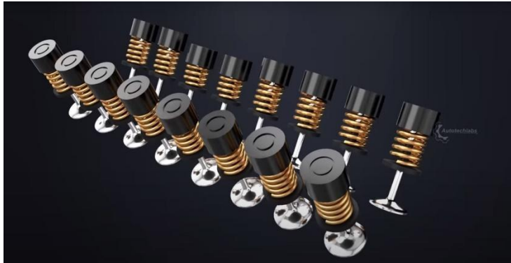
Εικόνα 2.3.5: Οι Βαλβίδες εισαγωγής καυσίμου και εξαγωγής καυσαερίων.
