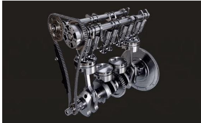
Εικόνα 2.2.1: Ο μηχανισμός του στροφαλοφόρου άξονα που συνδέεται με τα έμβολα μέσω του διωστήρα. Άνω οι δύο εκκεντροφόροι άξονες με τις βαλβίδες εισαγωγής και εξαγωγής.
