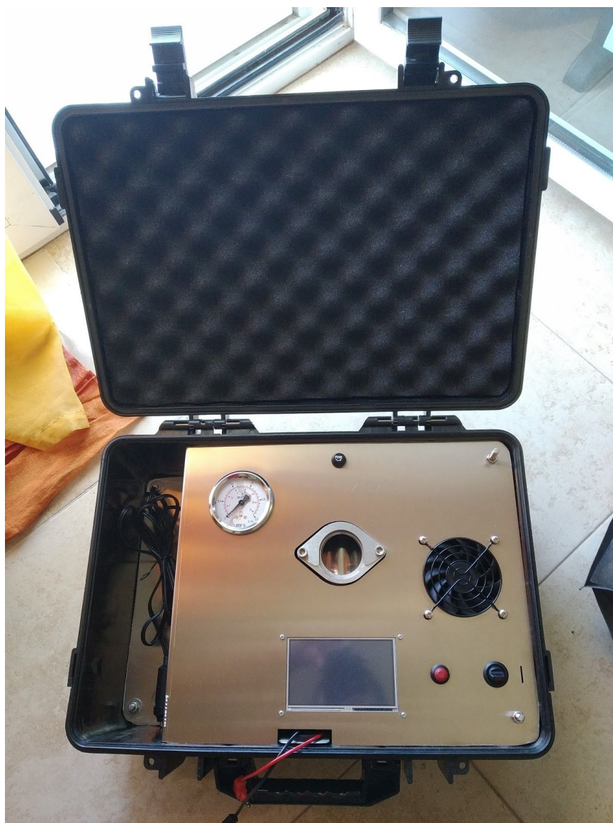
Εικόνα 74. Η συσκευή μέτρησης βαλβίδων «Pop Off», με το πέρας της διαδικασίας συναρμολόγησης
