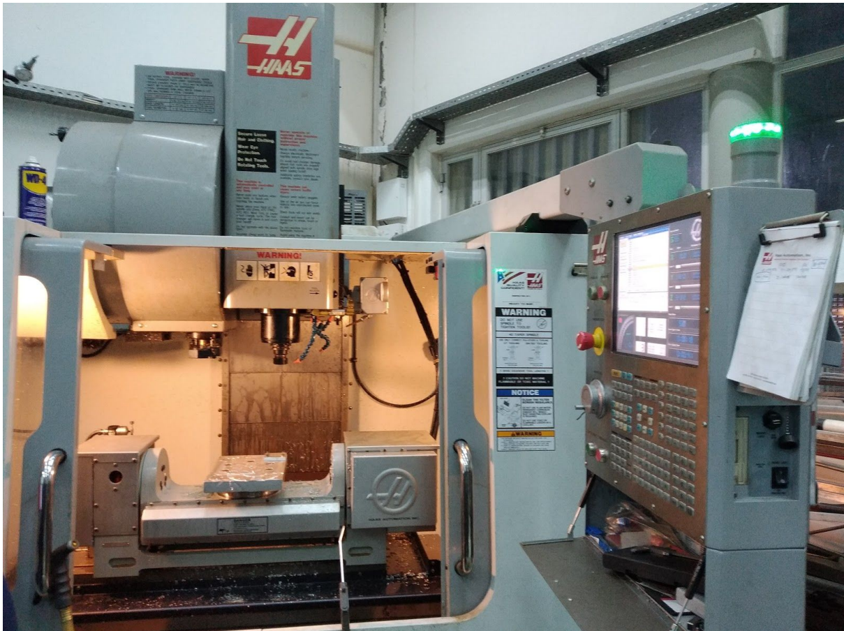
Εικόνα 55. Το κέντρο κατεργασίας ψηφιακής καθοδήγησης 5 αξόνων «HAAS VF 2» (Προσφορά του εργαστηρίου εργαλειομηχανών του Πολυτεχνείου Κρήτης)
