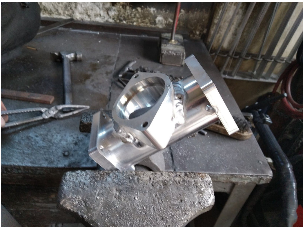
Εικόνα 67. Η διάταξη ημιτελώς συγκολλημένη (διακρίνονται οι πόντες στις φλάντζες 1)
