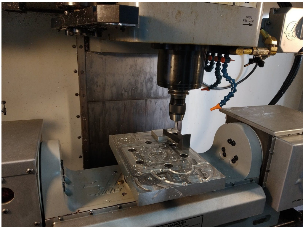
Εικόνα 58. Πρόσδεση δοκιμίου στην τράπεζα και εκκίνηση κοπής αυτού
