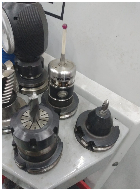
Εικόνα 57. Ενδεικτικά εργαλεία κοπής και μηδενισμού που χρησιμοποιήθηκαν για τις κατεργασίες των τεμαχίων (Προσφορά του Πολυτεχνείου Κρήτης)
