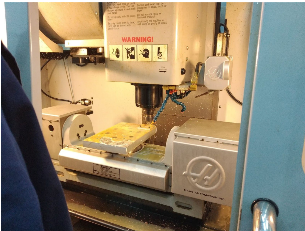
Εικόνα 59. Ρίψη ειδικού ψυκτικού υγρού κατά την διάρκεια της κοπής της φλάντζας 1
