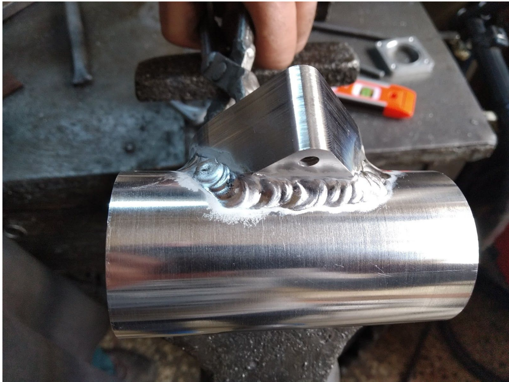
Εικόνα 66. Άποψη της δομής της ραφής της συγκόλλησης της φλάντζας 4
