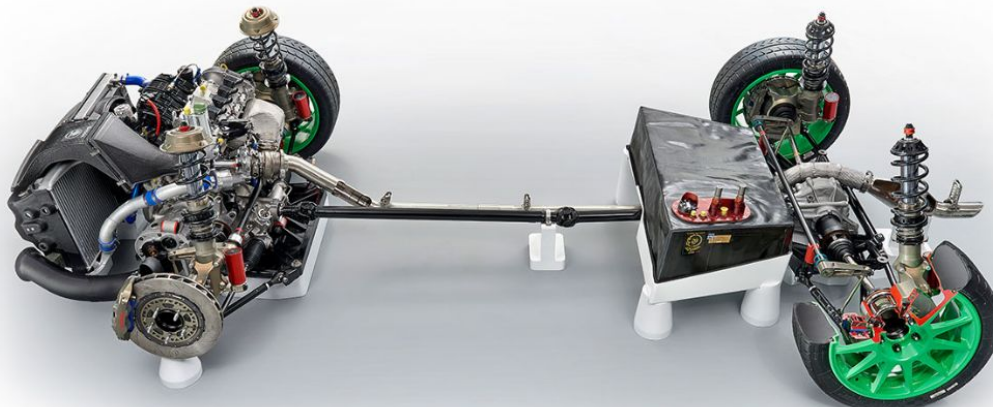
Εικόνα 4. Τα μηχανικά μέρη και το σύστημα κίνησης (Drivetrain), ενός αναγνωρισμένου αγωνιστικού οχήματος της ομάδας «Rally2» (Πηγή: skoda-motorsport.com )
