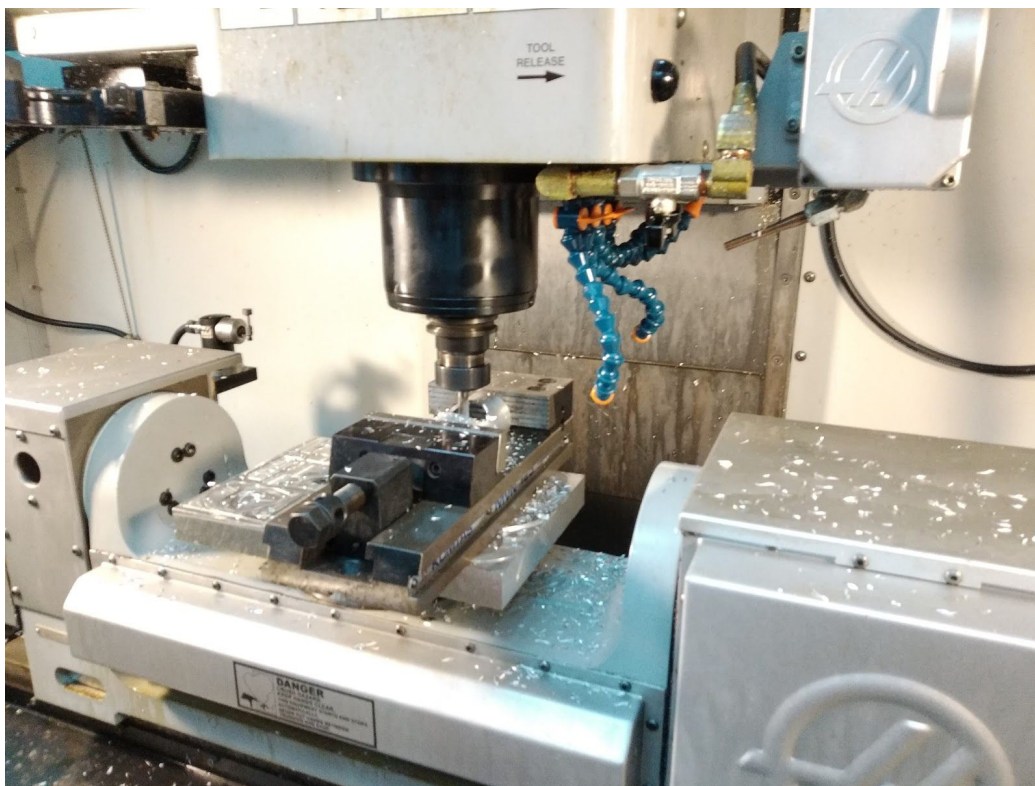
Εικόνα 60. Πρόσδεση και κοπή του σωλήνα της διάταξης
