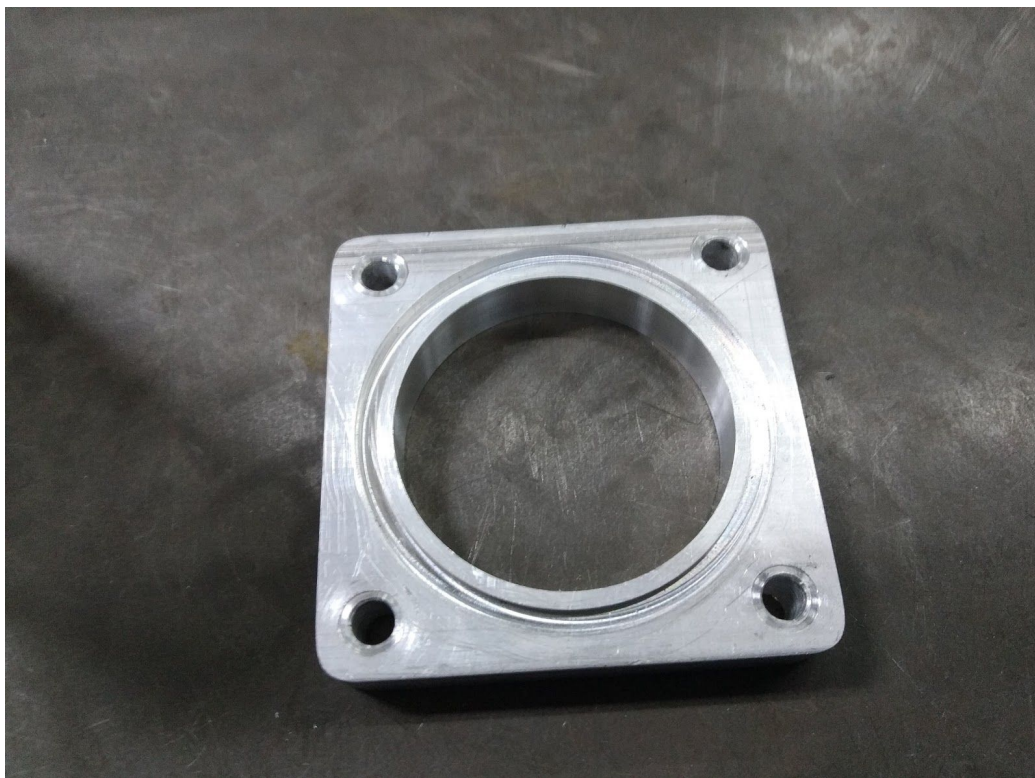
Εικόνα 61. Η φλάντζα 1 με το πέρας των κατεργασιών στην εργαλειομηχανή
