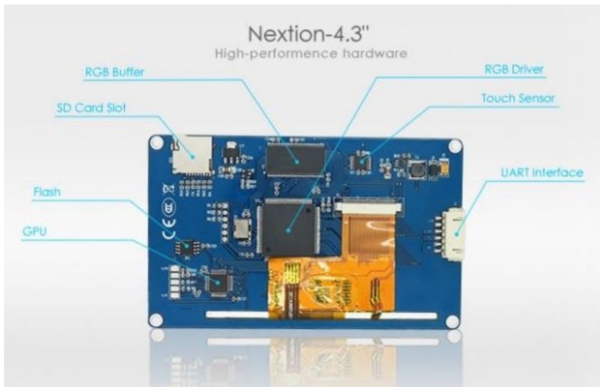
Εικόνα 77. Αναλυτική απεικόνιση της ενσωματωμένης πλακέτας της οθόνης (Πηγή: nextion.tech )
