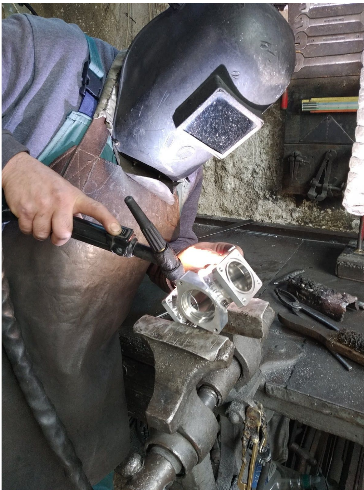
Εικόνα 65. Στιγμιότυπο κατά την διαδικασία της συγκόλλησης με την μέθοδο «T.I.G», των δομικών μεταλλικών τεμαχίων της διάταξης
