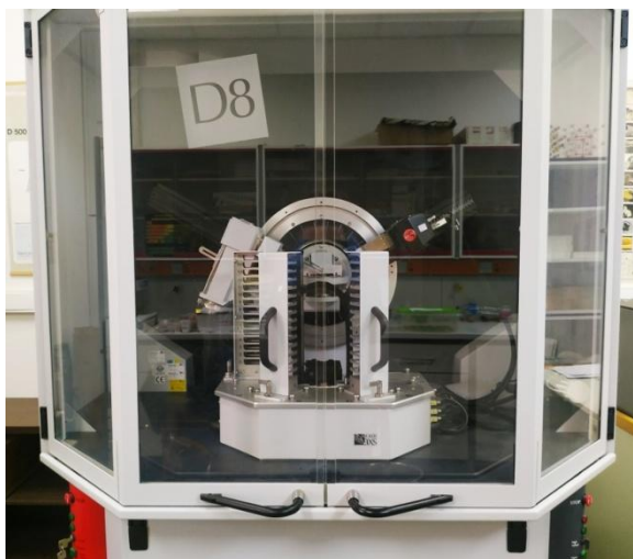
Εικόνα 9: Διάταξη XRD περιθλασιόμετρο.
