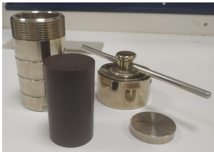
Εικόνα 16: Υδροθερμικός αντιδραστήρας.
