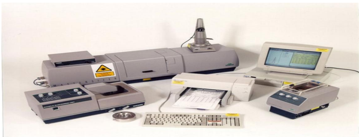
Εικόνα 12: Πειραματική διάταξη αναλυτή Mastersizer S της Malvern.
