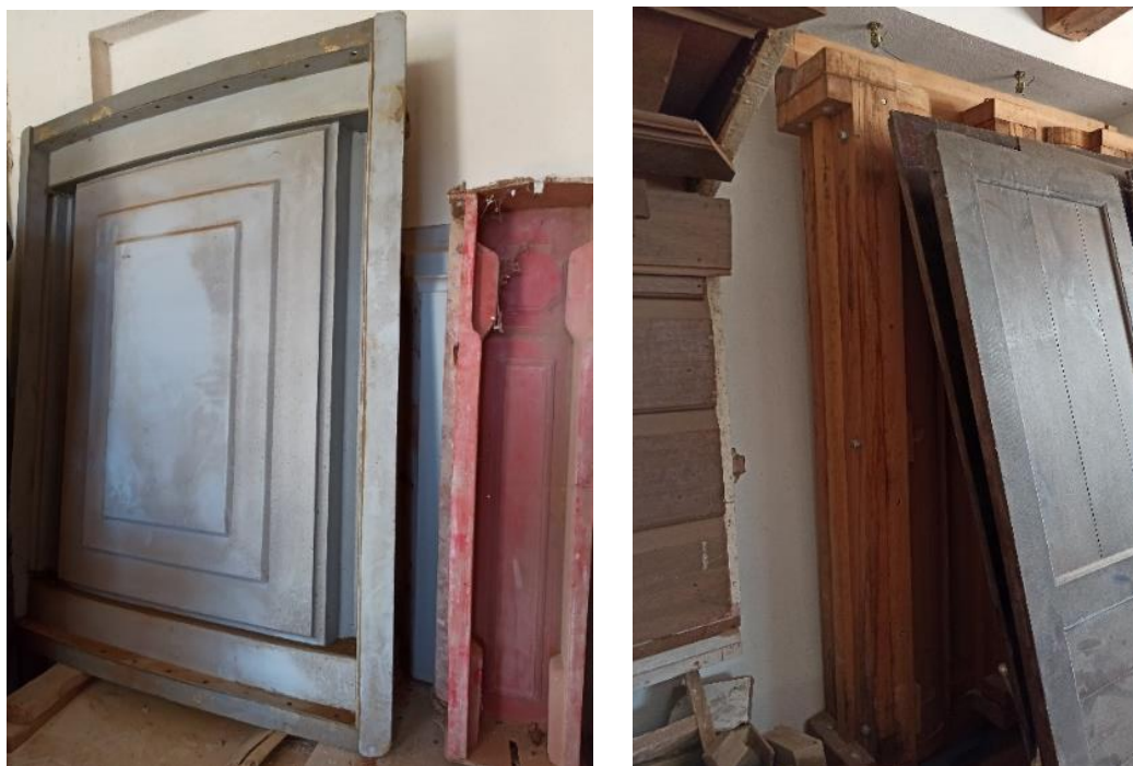
Εικόνα 28: Εσωτερικό πλαστικού καλουπιού (Αριστερά). - Εξωτερική πλευρά ξύλινου καλουπιού (Δεξιά).
