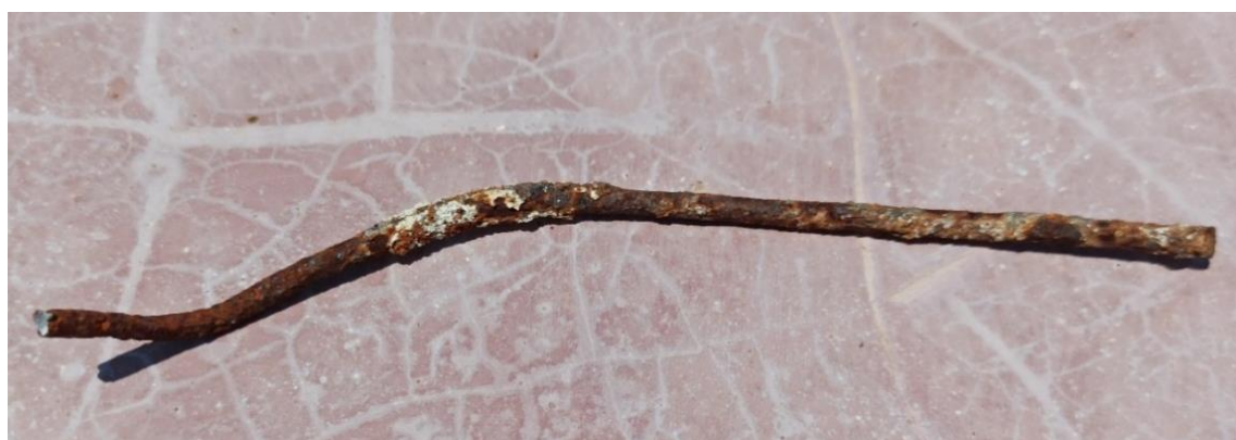
Εικόνα 22: Τμήμα σιδερένιας ράβδου από τους θόλους του Ι.Ν. της Ευαγγελίστριας στη Χαλέπα
