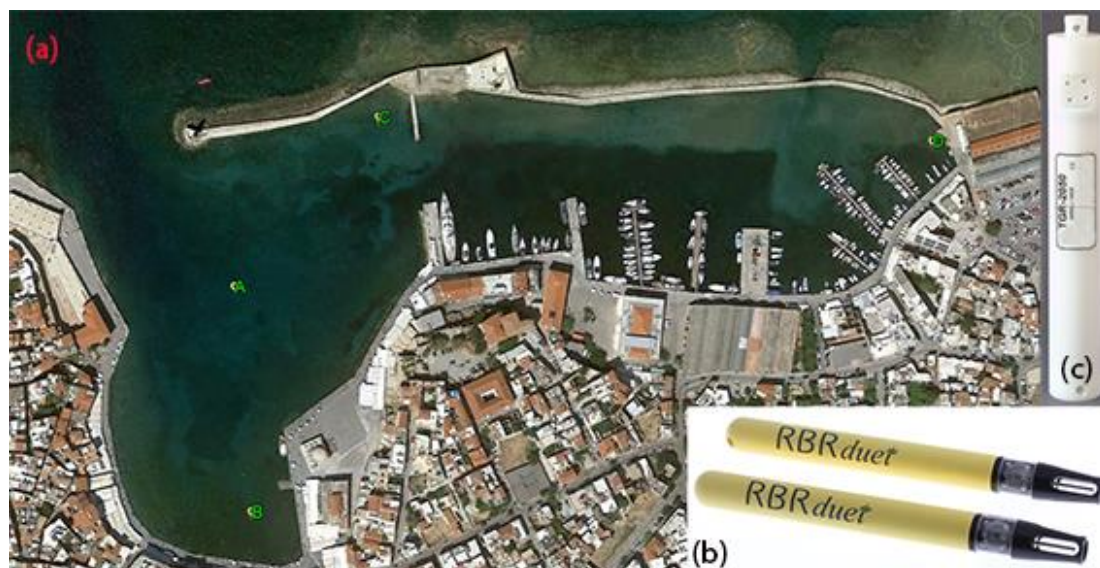
Εικόνα 21. Τοποθεσίες πόντισης κυματομετρητών πίεσης εντός του Ενετικού λιμένα (a). Συσκευές κυματομετρητών RBR-duet (b) και TWR-2050 (c).
