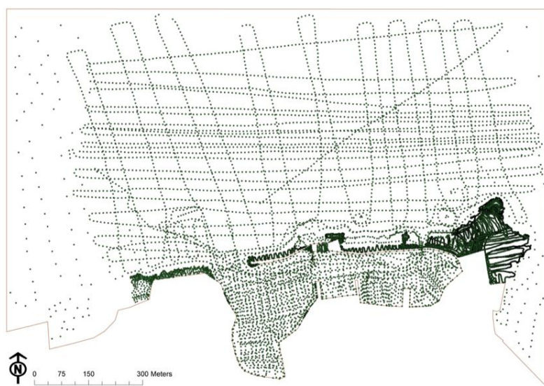
Εικόνα 22. Απεικόνιση όλων των μετρήσεων πεδίου, τοπογραφίας και βαθυμετρίας, που χρησιμοποιήθηκαν για τη δημιουργία του κανάβου.
