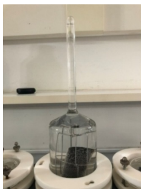
Εικόνα 6.5 Αριστερά εμφανίζεται η αυθόρμητη εκτόπιση εξανίου και ταυτόχρονη απορρόφηση νερού, ενώ δεξιά η εξαναγκασμένη εκτόπιση εξανίου από νερό.
