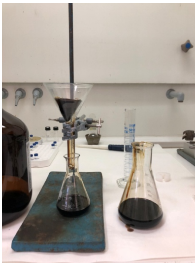
Εικόνα 6.1 Αριστερά φαίνεται οι μέθοδοι ογκομέτρησης και διήθησης πετρελαϊκού δείγματος Πρίνου και δεξιά η συνδεσμολογία για την εισπίεση πετρελαϊκού δείγματος στο δειγματοφορέα
