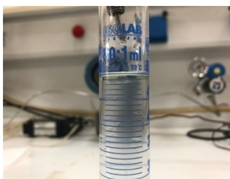
Εικόνα 6.5 Αριστερά εμφανίζεται η αυθόρμητη εκτόπιση εξανίου και ταυτόχρονη απορρόφηση νερού, ενώ δεξιά η εξαναγκασμένη εκτόπιση εξανίου από νερό.
