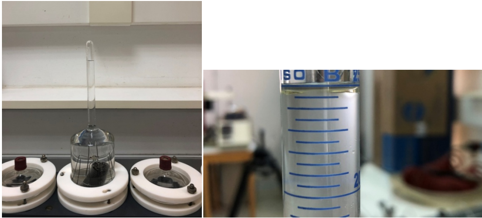
Εικόνα 6.3 Πρώτη φάση πειράματος Amott για προσδιορισμό του περιεχομένου σε νερό, αριστερά αυθόρμητη εκτόπιση εξανίου από νερό και δεξιά η ποσότητα εξανίου μετά από εξαναγκασμένη εκτόπιση από νερό.
