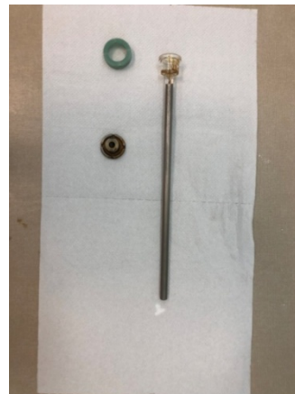
Εικόνα 5.9 Πενετόμετρο
