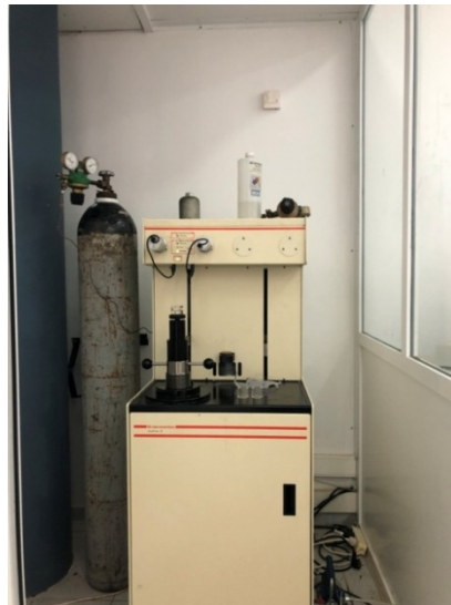
Εικόνα 5.8 Ποροσίμετρο Autopore IV 9500 από τη MICROMERITICS
