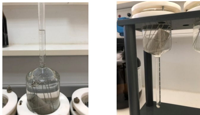
Εικόνα 5.17 Αριστερά η πρώτη φάση του πειράματος Amott για τον προσδιορισμό του περιεχομένου σε εξάνιο και δεξιά η δεύτερη φάση του πειράματος για τον προσδιορισμό του περιεχομένου σε νερό
