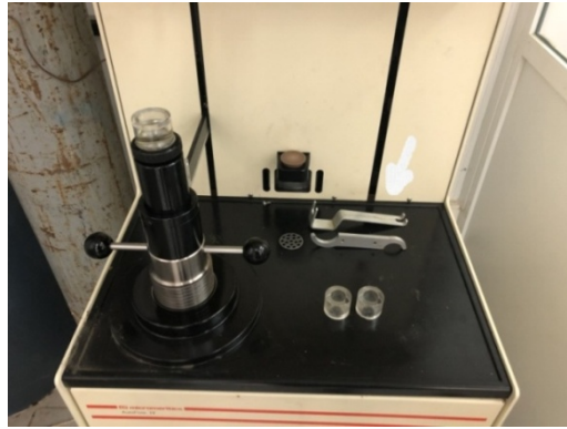
Εικόνα 5.10 Ειδικό εξάρτημα για το σφράγισμα του πενετομέτρου.
