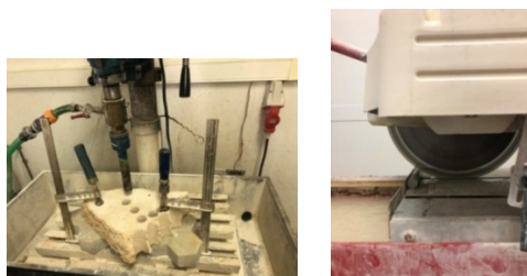
Εικόνα 5.1 Μηχάνημα κοπής πυρήνα συγκεκριμένης διαμέτρου και δεξιά το μηχάνημα κοπής πυρήνα συγκεκριμένου μήκους
