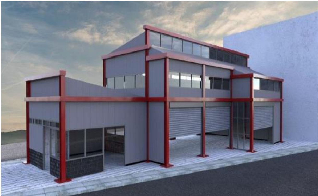
Σχήμα 4.1: Τρισδιάστατο μοντέλο της μεταλλικής κατασκευής
