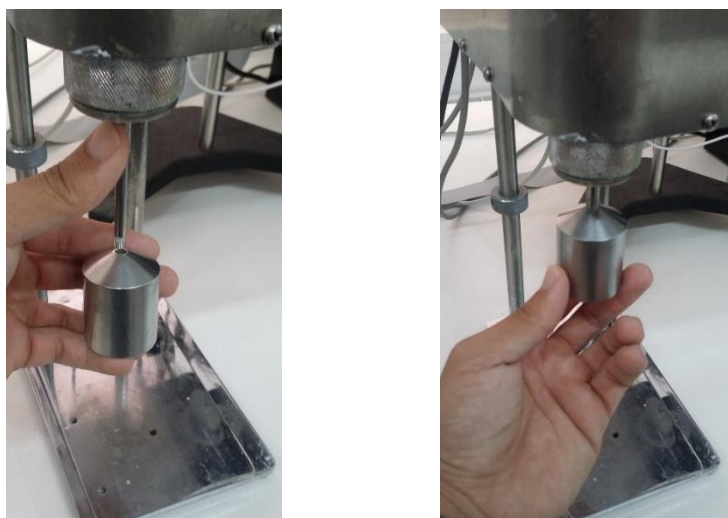
Εικόνα 3.21 Τοποθέτηση του μεταλλικού κυλίνδρου “Bob”
