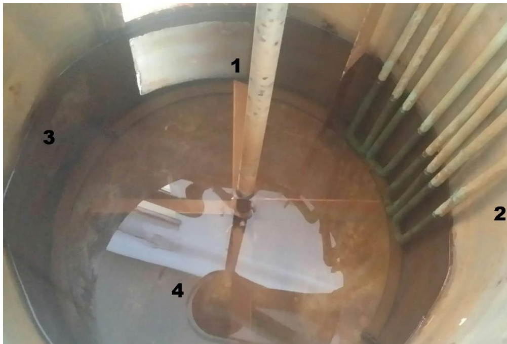
Εικόνα 3.8 Εσωτερικά της δεξαμενής 1. Σύστημα Ανάδευσης, 2. σύστημα ψύξης(σερπαντίνα), 3 Σύστημα έξοδου προς την αντλία και 4.σύστημα απορροής
