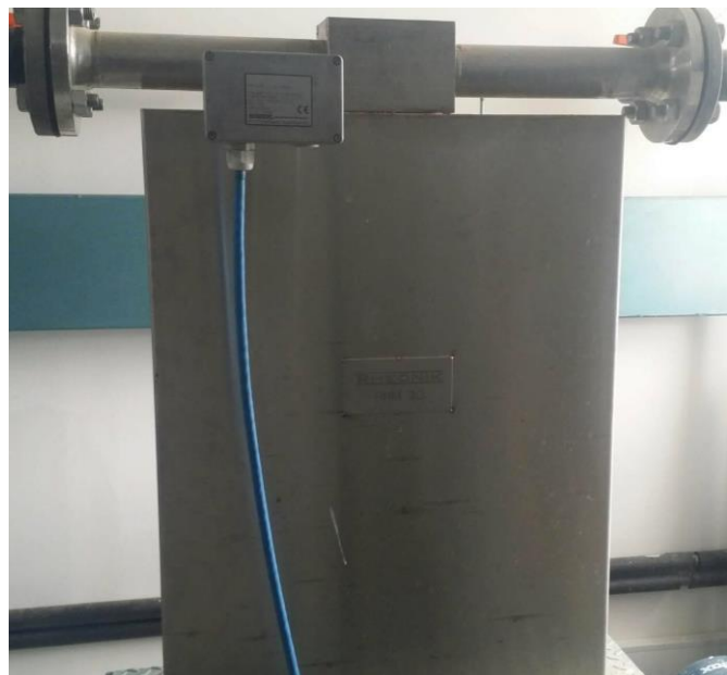
Εικόνα 3.10 Παροχόμετρο RHM 30 αισθητήρας ροής
