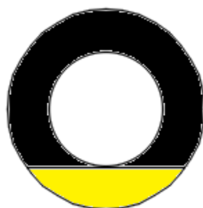
Εικόνα 3.53 Δακτυλιοειδής αγωγός με το στρώμα. Με κίτρινο χρώμα απεικονίζει το στρώμα, ενώ με μαύρο τη διατομή ενδιαφέροντος.
