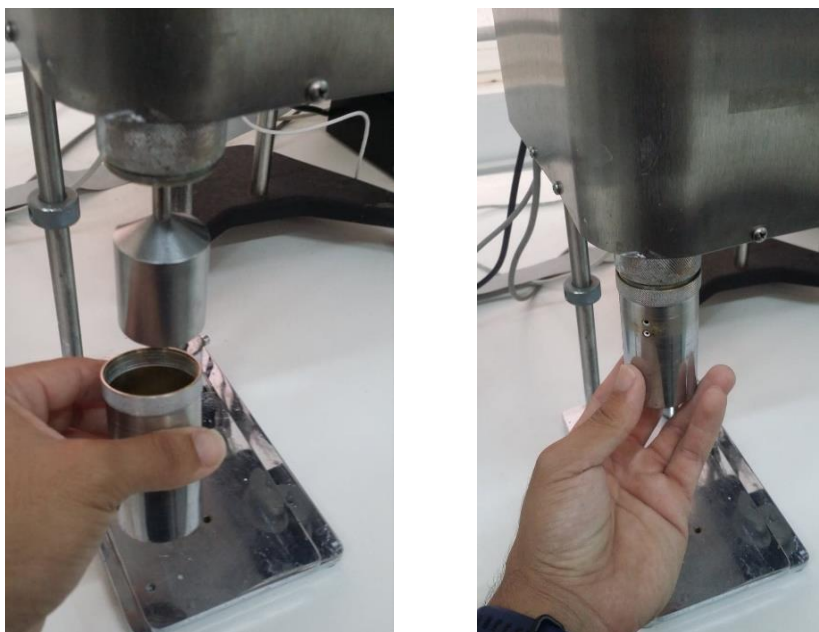
Εικόνα 3.22 Τοποθέτηση του ρότορα
