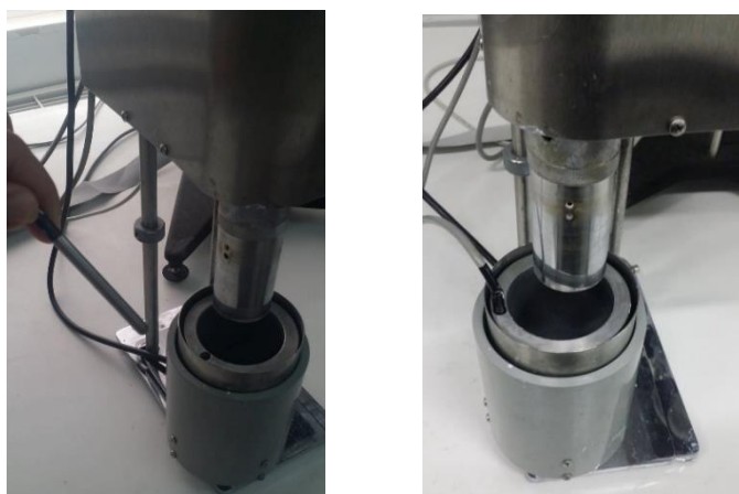
Εικόνα 3.25 Τοποθέτηση το εξάρτημα για μέτρηση θερμοκρασίας
