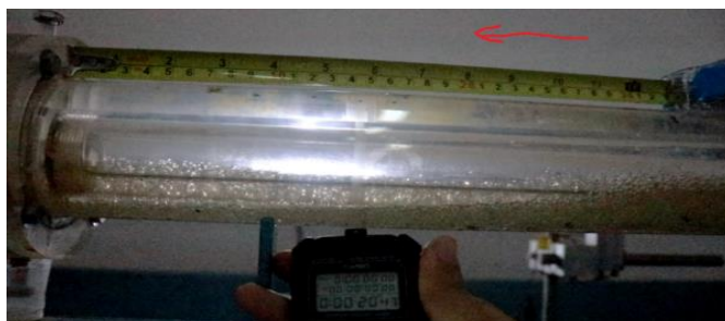
Εικόνα 3.36 Αρχική καταγραφή πορεία των σωματιδίων κατά την ροή από εικόνα μέσω της κάμερα. Η κατεύθυνση της ροής δείχνεται με το κόκκινο βέλος.
