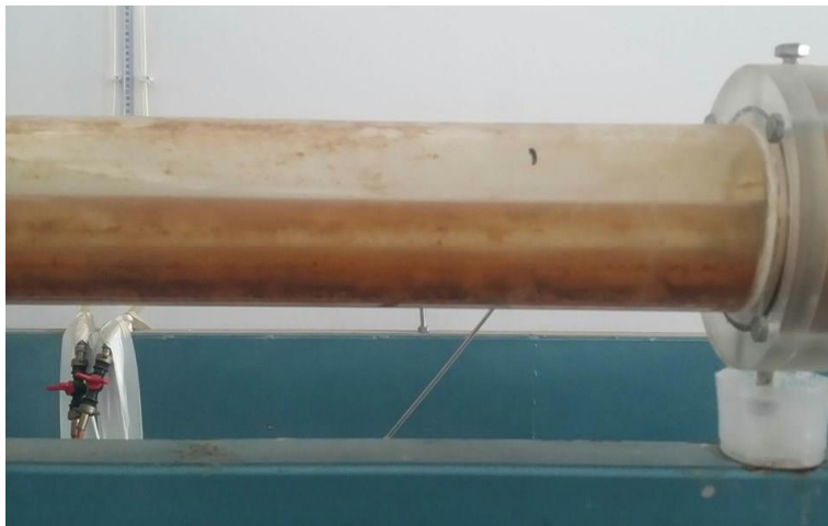
Εικόνα 3.3 Δακτύλιος και φλάντζα σύνδεσης τμημάτων δακτυλίου
