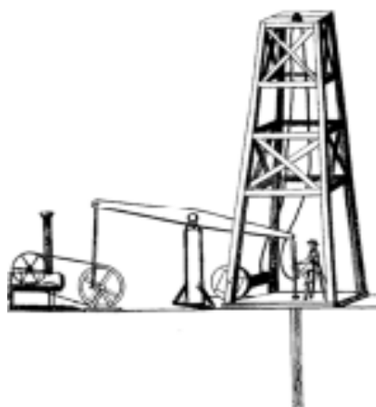
Εικόνα 1.6 Γεωτρύπανου τύπου Cable- tool με χρήση ατμοκινητήρα (Cable-tool drilling (Percussion Drilling), 2018)
