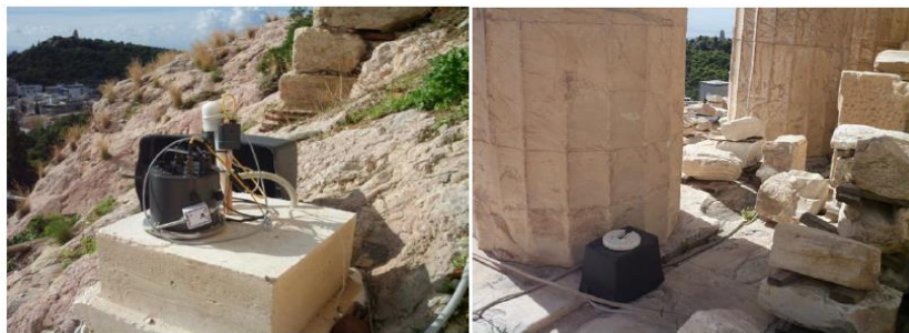
Εικόνα 4.15: Σύστημα εγκατεστημένου επιταχυνσιογράφου (Karogianni et al., 2019).
