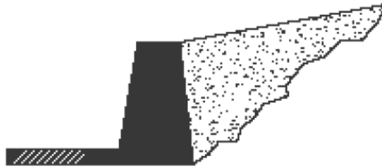
Εικόνα 1.2: Τυπική διατομή τοίχου βαρύτητας (Kramer, 1996).
