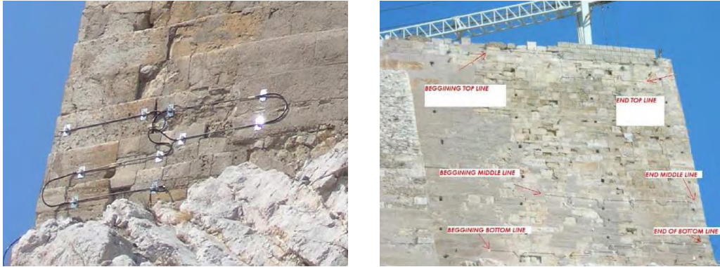
Εικόνα 4.12: Διατάξεις SMARTRODS επί της βάσης του ανατολικού (αριστερά) και νότιου (δεξιά) τείχους (Astreinidis & Egglezos, 2008).
