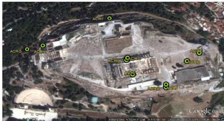
Εικόνα 4.14: Θέσεις των εγκατεστημένων επιταχυνσιογράφων στο λόφο της Ακρόπολης (Ψαρρόπουλος κ.α., 2019).
