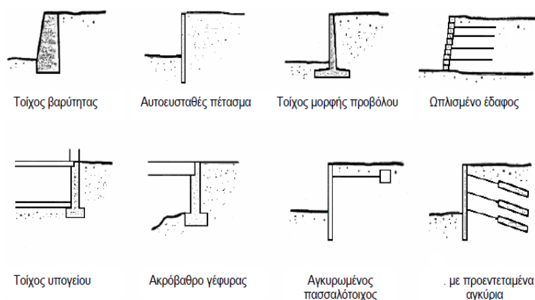
Εικόνα 1.1: Τύποι τοίχων αντιστήριξης (Kramer, 1996).
