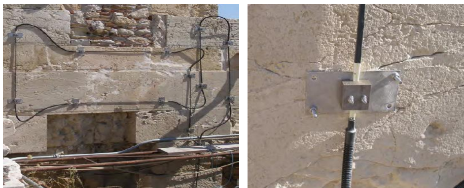
Εικόνα 4.10: Τυπική διάταξη αισθητήρων επί του τείχους (αριστερά) και αγκύρωση αισθητήρα με ανοξείδωτη αγκυρόπλακα (δεξιά) (Astreinidis & Egglezos, 2008).
