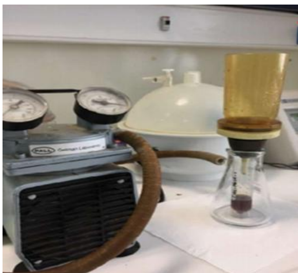
Εικόνα 10 : Διαδικασία διήθησης δειγμάτων ύστερα από την ανάδευση τους με συσκευή διήθησης κενού
