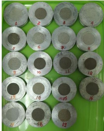
Εικόνα 4: Δειγματοφορείς για ποσοτική ανάλυση (Οι δύο επιπλέον δειγματοφορείς υφίστανται για την ποσοτική ανάλυση της αρχικής τέφρας και της πλυμένης τέφρας).
