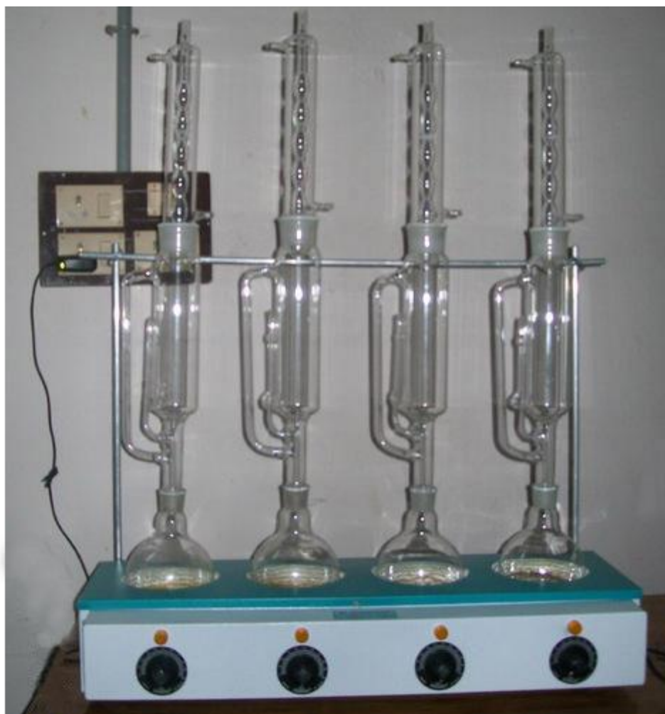
Εικόνα 27 Διάταξη Soxhlet ( http://labtek.co.in/soxhlet-extraction-unit/ )
