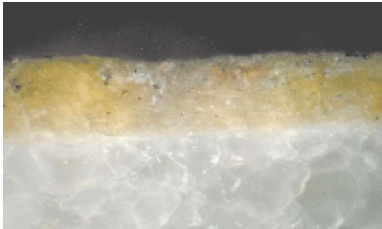
ΕΙΚΟΝΑ 1.7. ΔΙΑΤΟΜΗ ΦΥΣΙΚΗΣ ΠΑΤΙΝΑΣ (ΚΙΤΡΙΝΩΠΗ ΑΠΟΧΡΩΣΗ) ΟΞΑΛΙΚΟΥ ΑΣΒΕΣΤΙΟΥ ΣΕ ΜΑΡΜΑΡΙΝΟ ΜΝΗΜΕΙΟ
