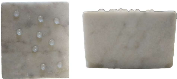
ΕΙΚΟΝΑ 5.43. ΔΟΚΙΜΙΟ ΑΠΟ ΜΑΡΜΑΡΟ CARRARA ΜΕ ΕΦΑΡΜΟΓΗ ΥΛΙΚΟΥ (ΣΤΑΓΟΝΑ-ΥΔΡΟΦΟΒΙΚΟΤΗΤΑ)
