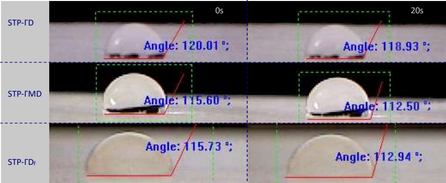
ΕΙΚΟΝΑ 5.57. ΓΩΝΙΕΣ ΕΠΑΦΗΣ ΣΕ ΕΠΙΣΤΡΩΜΕΝΕΣ ΕΠΙΦΑΝΕΙΕΣ ΔΟΚΙΜΙΩΝ ΑΠΟ ΠΕΝΤΕΛΙΚΟ ΜΑΡΜΑΡΟ (ΠΡΙΝ UV)
