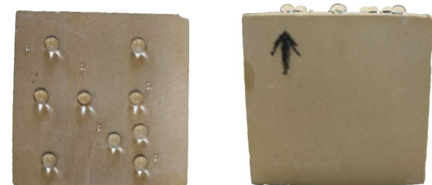
ΕΙΚΟΝΑ 5.30. ΔΟΚΙΜΙΟ ΑΠΟ ΑΛΦΑ ΜΕ ΕΦΑΡΜΟΓΗ ΥΛΙΚΟΥ (ΣΤΑΓΟΝΑ-ΥΔΡΟΦΟΒΙΚΟΤΗΤΑ)
