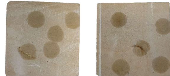
ΕΙΚΟΝΑ 5.29. ΔΟΚΙΜΙΑ ΑΠΟ ΑΛΦΑ ΧΩΡΙΣ ΕΦΑΡΜΟΓΗ ΥΛΙΚΟΥ (ΑΠΟΡΡΟΦΗΦΗ ΣΤΑΓΟΝΑΣ)
