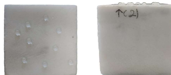
ΕΙΚΟΝΑ 5.56. ΔΟΚΙΜΙΟ ΑΠΟ ΠΕΝΤΕΛΙΚΟ ΜΑΡΜΑΡΟ ΜΕ ΕΦΑΡΜΟΓΗ ΥΛΙΚΟΥ (ΣΤΑΓΟΝΑ-ΥΔΡΟΦΟΒΙΚΟΤΗΤΑ)
