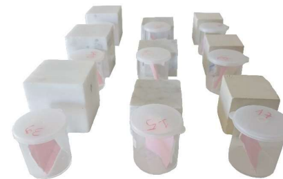
ΕΙΚΟΝΑ 4.18. ΔΟΚΙΜΙΑ ΚΑΙ ΠΛΑΣΤΙΚΑ ΔΟΧΕΙΑ ΜΕ ΔΕΙΓΜΑΤΑ ΑΠΟ SCOTCH TAPE
