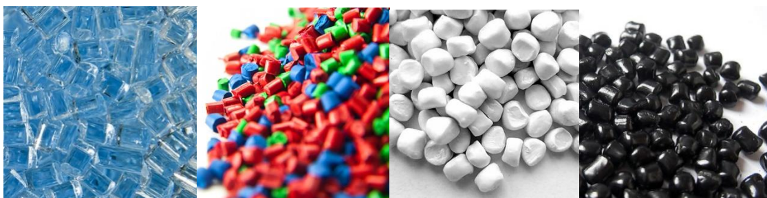
Εικόνα 2.2. Κόκκοι masterbatches με διάφορα πρόσθετα
