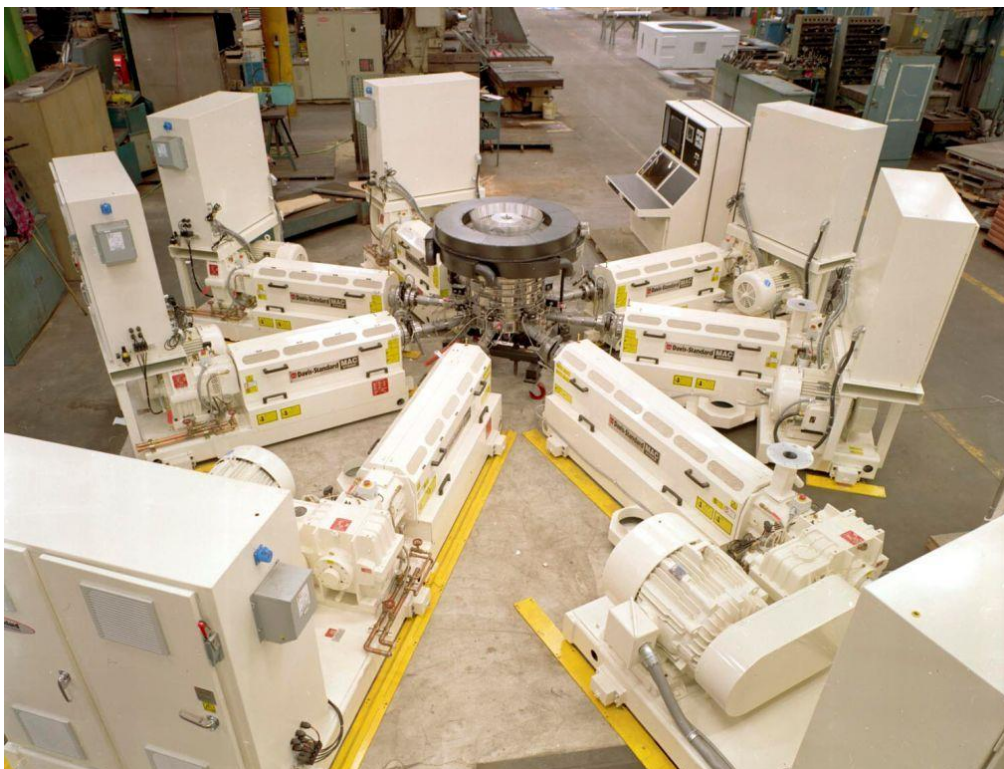
Εικόνα 3.9. Επτα-στρωματική γραμμή παραγωγής πολυμερικού φύλλου.
