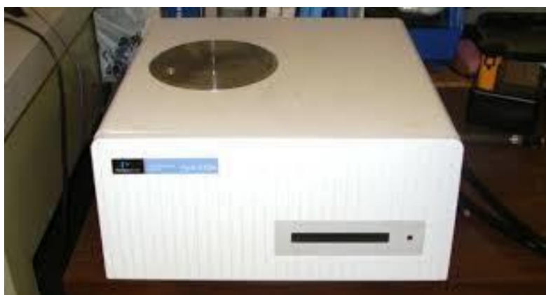
Σχήμα 3.3: Θερμοζυγός Pyris 6 TGA, εταιρίας PerkinElmer
