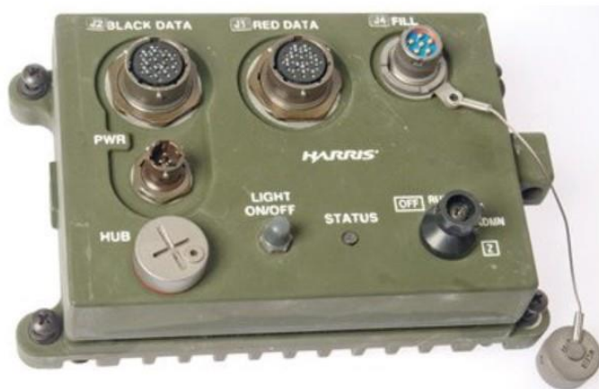
Εικόνα 21. Συσκευή κρυπτογράφησης Kgv-72 Type-1 (Harris Corporation. 2009)
