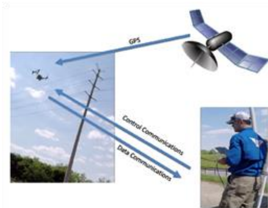
Εικόνα 24. Σχήμα ενός μικρού εμπορικού drone με OCU / GCS, UAV, GPS και τις επικοινωνίες Krishna & Murphy, 2017
