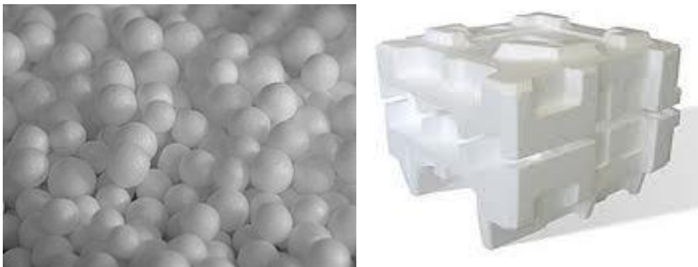
Εικόνα 4.7.: Κόκκοι διογκώσιμου πολυστυρενίου – τελικό προϊόν
