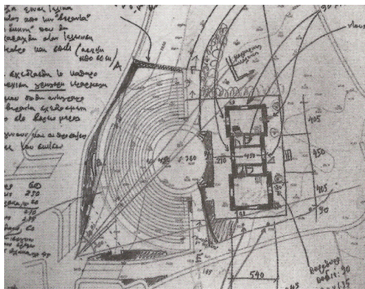
Εικ. 200: Σκίτσο του Δοξιάδη πάνω σε φωτοτυπημένη κάτοψη του θεάτρου, όπου δίνει οδηγίες για τη σκηνή σύμφωνα με το πολικό σύστημα συντεταγμένων.
