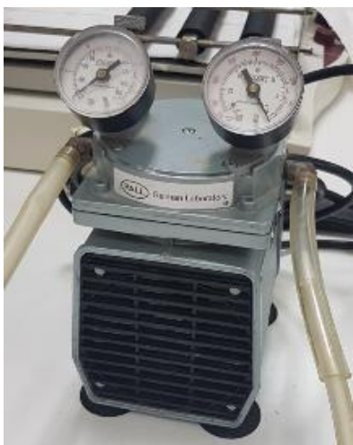
Εικόνα 8.8. Αντλία κενού PALL.
