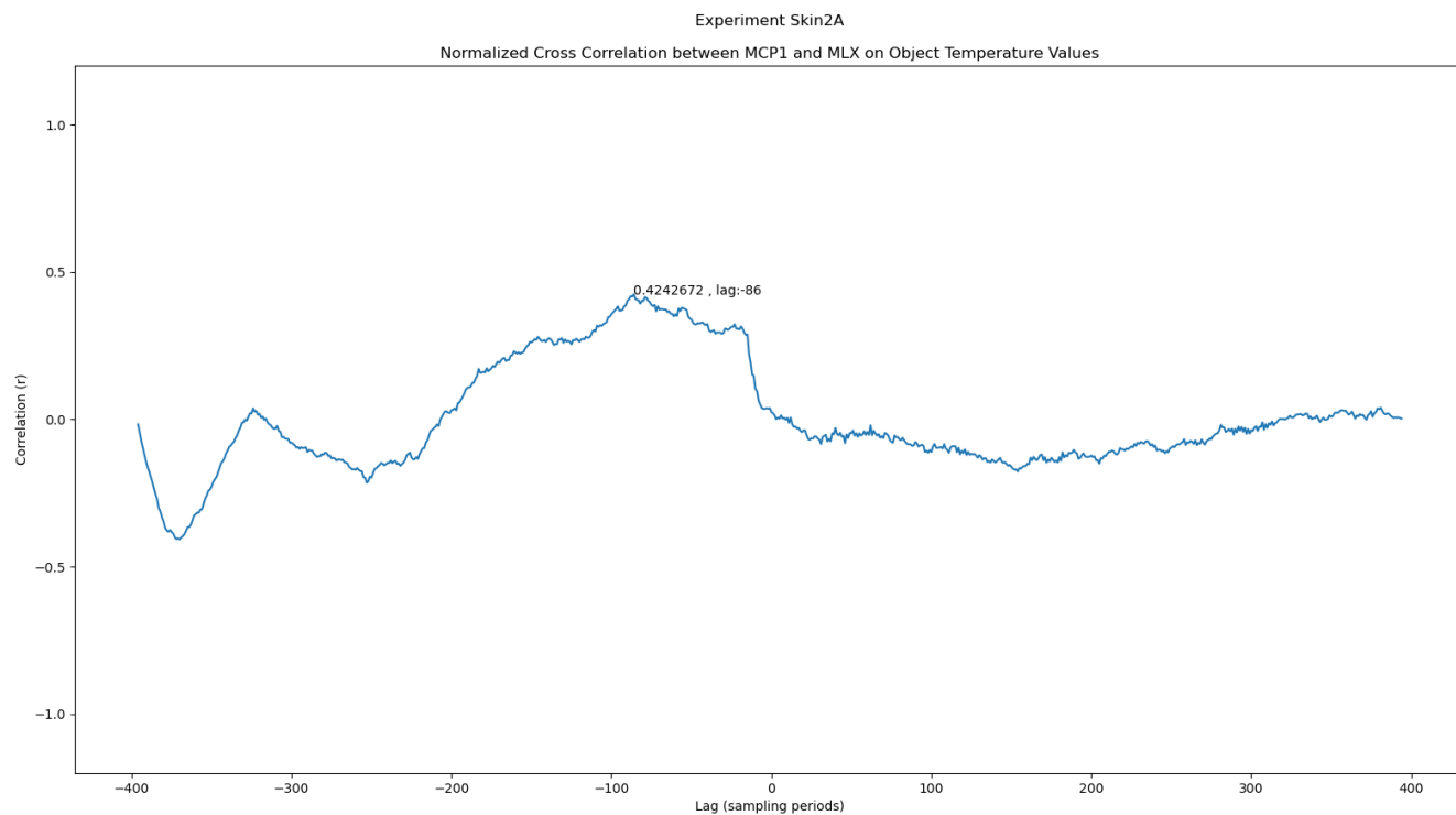
Σχήμα 5. 50 Πείραμα Skin2A - Normalized Cross Correlation σημάτων MCP1 και MLX on Object
