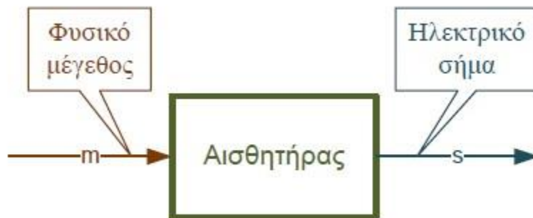
Σχήμα 2. 1 Σχηματική διάταξη ενός αισθητήρα
