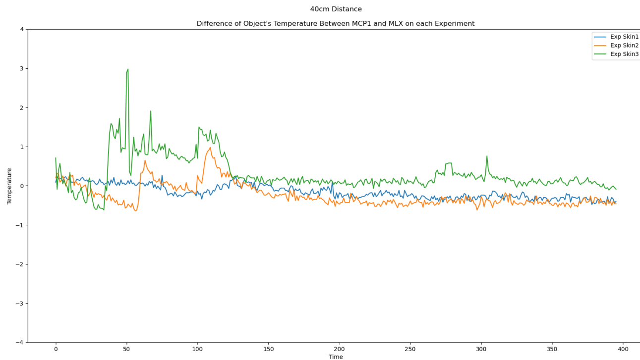
Σχήμα 5. 30 Διαφορά σημάτων MCP1 και MLX Object στην απόσταση 40cm στα πειράματα Skin
