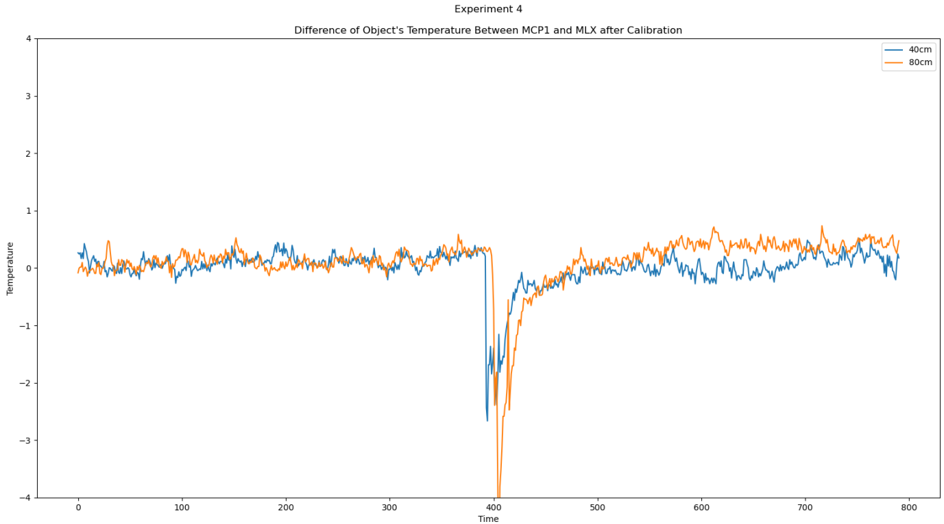
Σχήμα 5. 63 Πείραμα 4 – Διαφορά MCP1-MLXObj μετά από βαθμονόμηση
