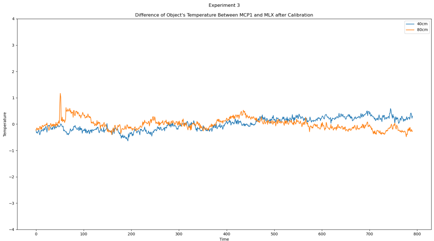
Σχήμα 5. 62 Πείραμα 3 – Διαφορά MCP1-MLXObj μετά από βαθμονόμηση
