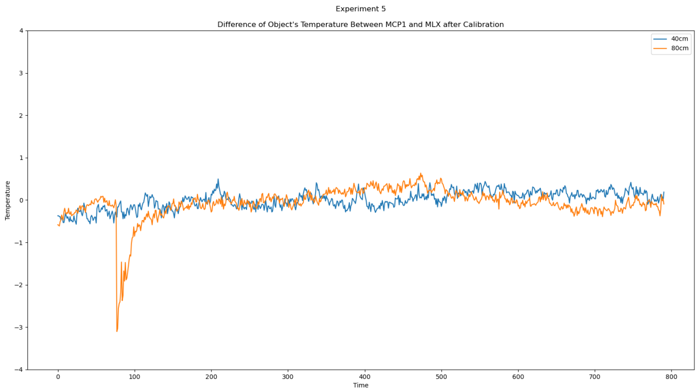
Σχήμα 5. 64 Πείραμα 5 – Διαφορά MCP1-MLXObj μετά από βαθμονόμηση
