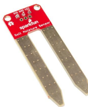
Σχήμα 3. 19 Πίσω όψη Soil Moisture Sensor
