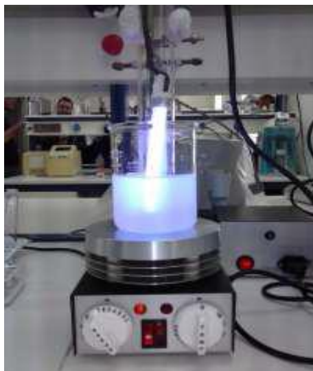
Εικόνα 6: Πειραματική διάταξη φωτοκατάλυσης παρουσία ακτινοβολίας UVA.
