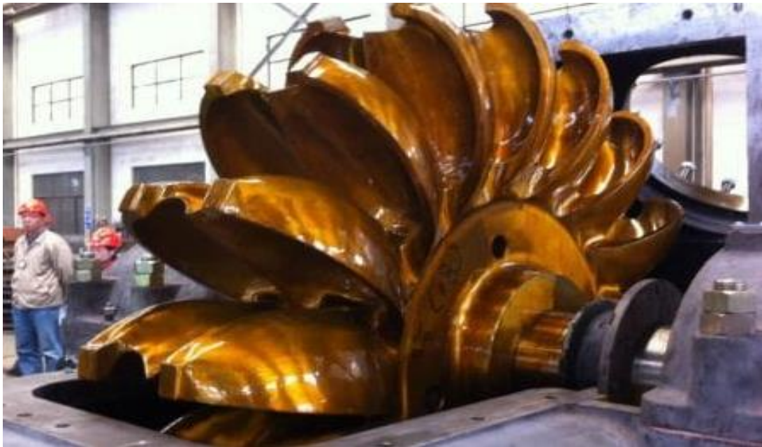
Εικόνα 5.2 Μηχανή Pelton.
