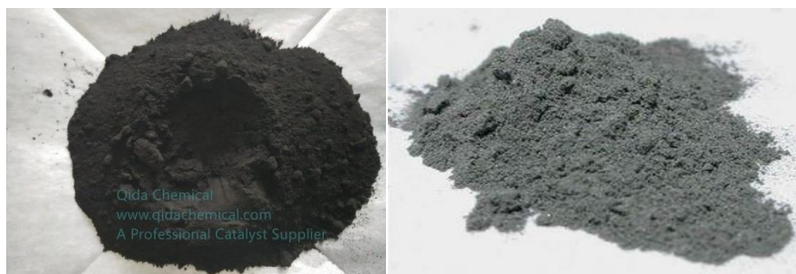
2.2.1: Καταλύτης Νικελίου (Ni) και καταλύτης Ιριδίου (Ir) αντίστοιχα
