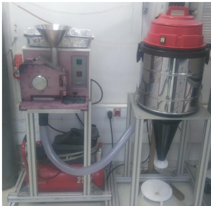
Εικόνα 1 : Διάταξη μύλου άλεσης και κυκλώνα περιδίνησης
