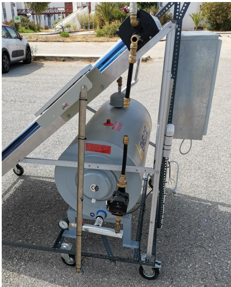
Figure 2.39: Δημιουργία κλειστού κυκλώματος με την τοποθέτηση κυκλοφορητή και ροόμετρου
