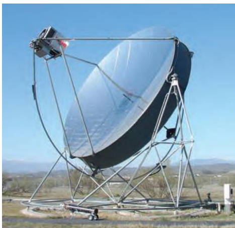
Figure 1.22: Σύστημα ηλιακού δίσκου με μηχανή Stirling [1]
