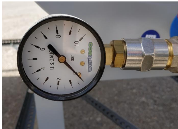
Figure 2.63: Ένα τυπικό μανόμετρο Bourdon
