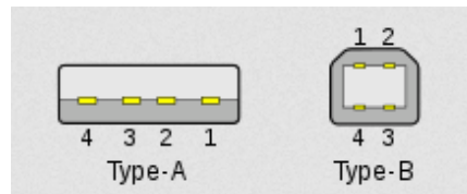
Σχήμα 3.4 : Φυσική μορφή των “Type A” και “Type B” USB Connectors με αριθμημένες επαφές
