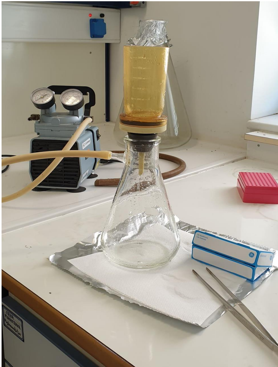
Εικόνα 8: Διαδικασία Διήθησης. Αριστερά η συσκευή της διήθησης.
