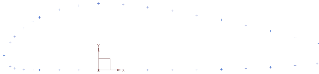
Εικόνα 6.2.1. Τα σημεία των συντεταγμένων της αεροτομής στο Nx Siemens 11.0.
