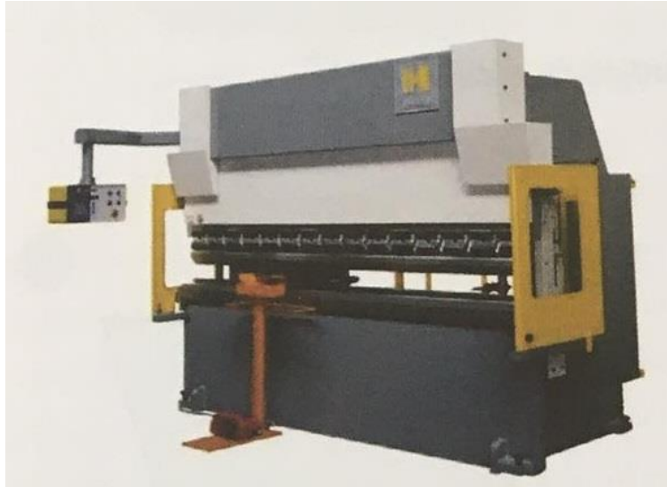
Εικόνα 5.5.3. Υδραυλική μηχανή κάμψης (στράντζα).
