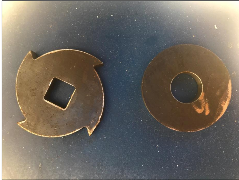
Φωτ. Νο 11. (Κοπτικός δίσκος 4 ων αιχμών και αποστάτης αυτού)
