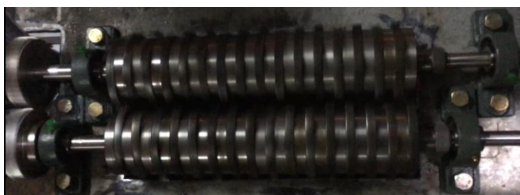
Φωτ. Νο 6. (Μηχανισμός θρυμματισμού – κοπτικοί δίσκοι 4 αιχμών)
