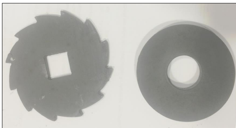
Φωτ. Νο 12. (Νέος κοπτικός δίσκος και αποστάτης αυτού στην τελική τους μορφή)
