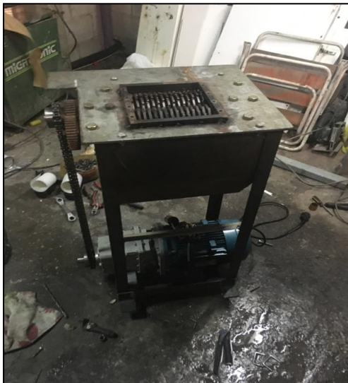
Φωτ. Νο 13,14,15,16 . (Στάδια κατασκευής του θραυστήρα)
