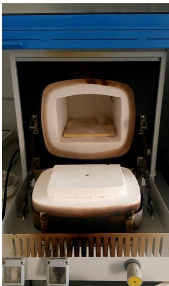
Εικόνα 2. 9: Φούρνος έψησης δοκιμίων
