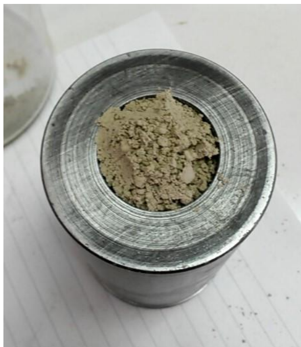
Εικόνα 2. 6: Καλούπι μορφοποίησης με μείγμα
