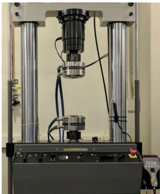
Εικόνα 2. 18: Μηχανή φόρτισης MTS 800
