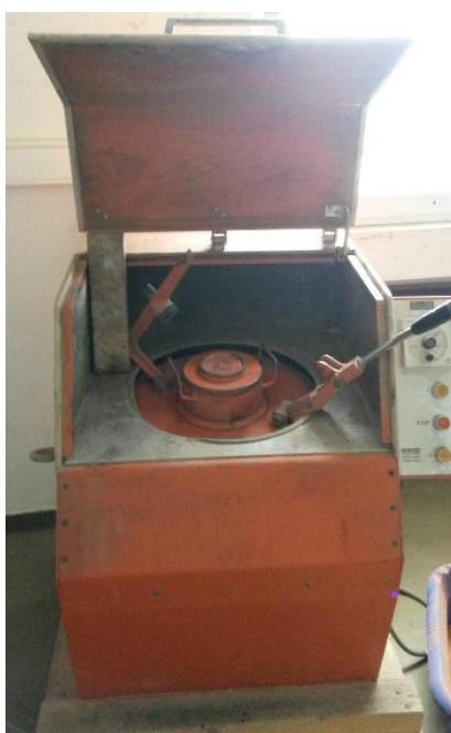
Εικόνα 2. 4: Πλανητικός μύλος Bico Pulverizer
