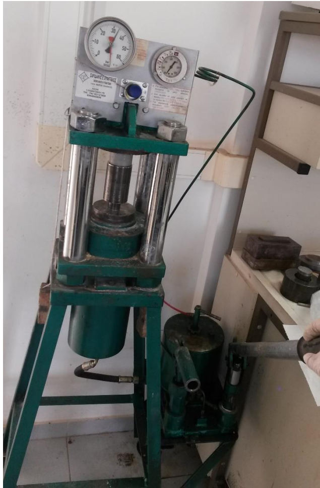
Εικόνα 2. 7: Υδραυλική πρέσα συμπίεσης
