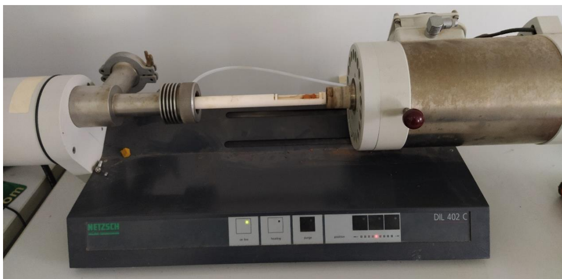
Εικόνα 2. 21: Διαστολόμετρο Netzsch DIL 402C
