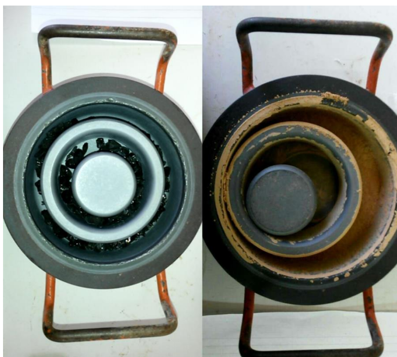
Εικόνα 2. 5: Λειοτρίβηση γυαλιού
