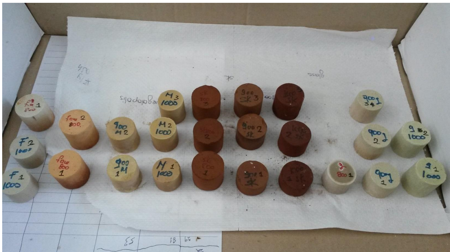
Εικόνα 2. 11: Παραγόμενα υαλοκεραμικά (FAM, FA, FAS, FAG) μετά από την έψησή τους στους 800 °C, 900 °C και 1000 °C.
