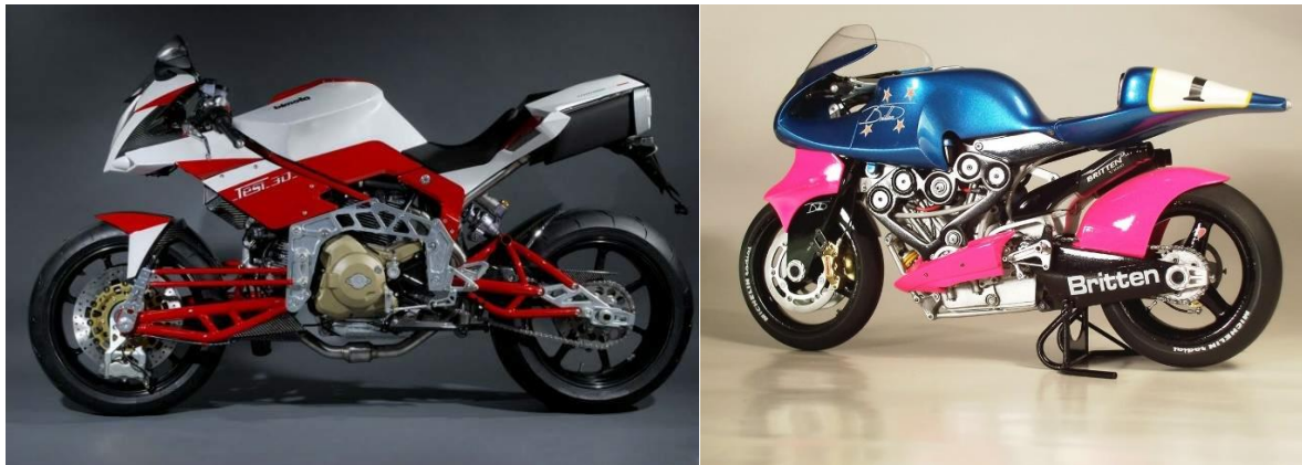
Εικόνα 6: Αριστερά η Bimota Tesi 3D με το σύστημα Hub – steering (Πηγή Motorcycle Specs) και δεξιά η Britten V1000, μία από τις καλύτερες μοτοσυκλέτες που έχουν κατασκευαστεί (Πηγή Moto Networks).
