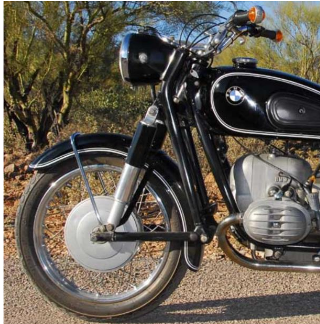
Εικόνα 3: BMW R60/2 με το μπροστινό σύστημα του Earle (Πηγή Wikipedia)
