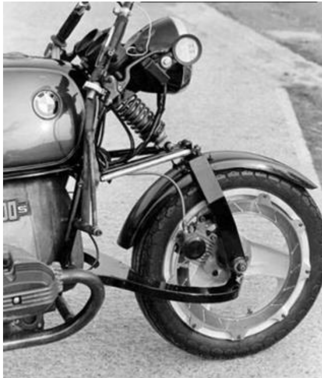
Εικόνα 8: Πρωτότυπο μπροστινό σύστημα με μονόπλευρο ψαλίδι [5]
