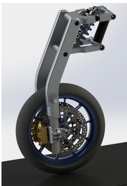
Εικόνα 1: Μπροστινό girder της Britten V1000 (Πηγή Grabcad)
