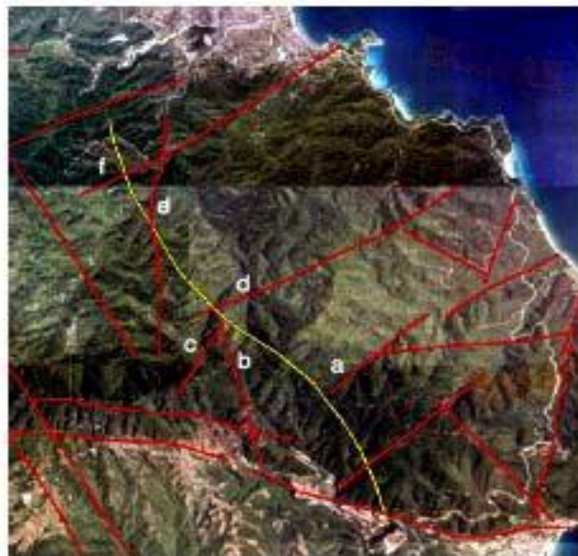
Εικόνα 2.4.:Χάραξη της σήραγγας με διαδρομή σχήματος “S” στο απόσπασμα αεροφωτογραφίας με τα ρήγματα που ενδεχομένως θα συναντήσει. Πηγή: Θεοδωρακόπουλος & Λεκίδης, 2017.
