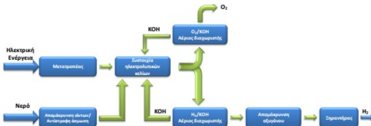
Σχήμα 1.3: Διάγραμμα ροής μίας αλκαλικής συσκευής ηλεκτρόλυσης για την παραγωγή H_2 . [1]
