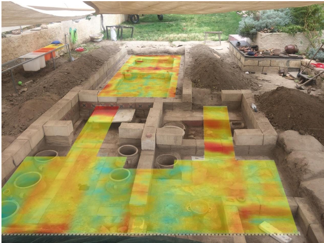
Σχήμα 4.20: Υπέρθεση των οριζόντιων τομών γεωραντάρ πάνω στην φωτογραφία της περιοχής διασκόπησης
