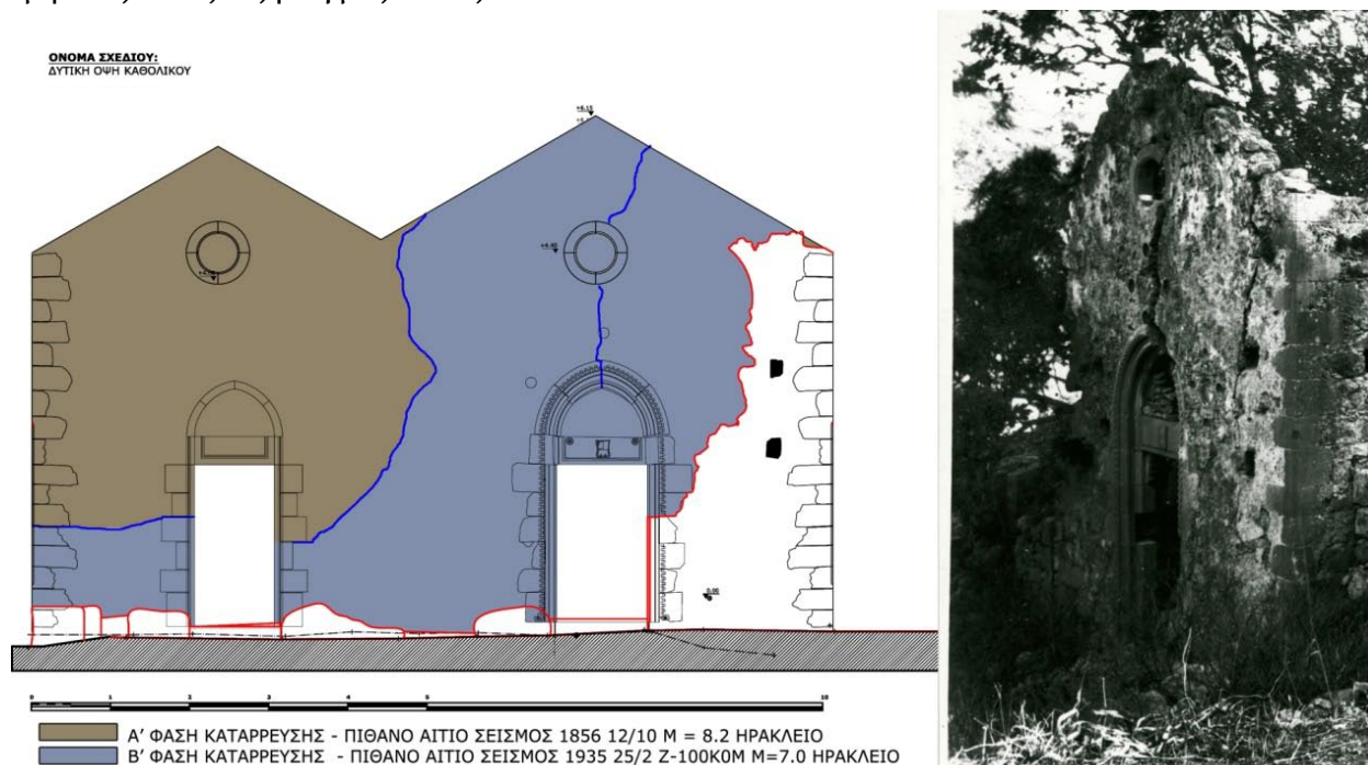
ΕΙΚΟΝΑ 101. Δυτική όψη της εκκλησίας του Αγ. Αντωνίου (αριστερά) όπου απεικονίζονται με διαφορετικό χρώμα δυο διαφορετικές φάσεις κατάρρευσης του δυτικού τοίχου σύμφωνα με την φωτογραφία του Gerola (εικ. 56) όπου στις αρχές του αιώνα διασώζεται ακόμη ο δυτικός τοίχος του νότιου κλίτους του ναού, στο ακέραιο. Το τμήμα της όψης που διακρίνεται με λευκό χρώμα είναι η υφιστάμενη κατάσταση διατήρησης του δυτικού τοίχου.
