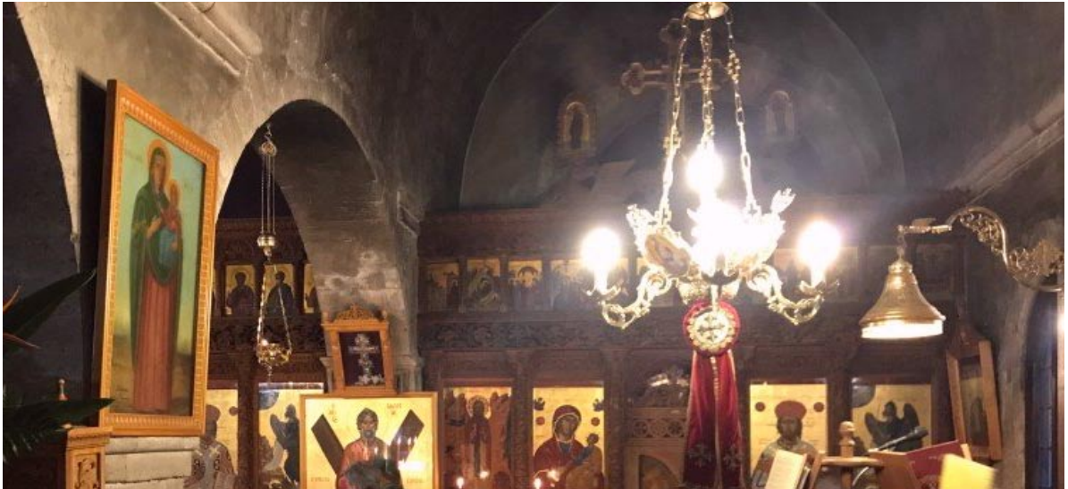
ΕΙΚΟΝΑ 38: Εσωτερική άποψη του ναού στο νότιο κλίτος όπου διακρίνονται τα ημικυκλικής καμπυλότητας λαξευτά τόξα που ενώνουν τα δυό κλίτη, τα οποία έχουν μεγαλύτερο συνολικό ύψος συγκριτικά με άλλους ναούς, λόγω υψηλότερης στάθμης εδράσεως με βάση το ύψος του μεσαίου πεσσού. Ακομή διακρίνεται εδώ η διακόσμηση της στάθμης γεννέσεως του θόλου της οροφής, κάτι το οποίο επίσης δεν συνιθίζεται σε εκκλησίες της υπαίθρου.
