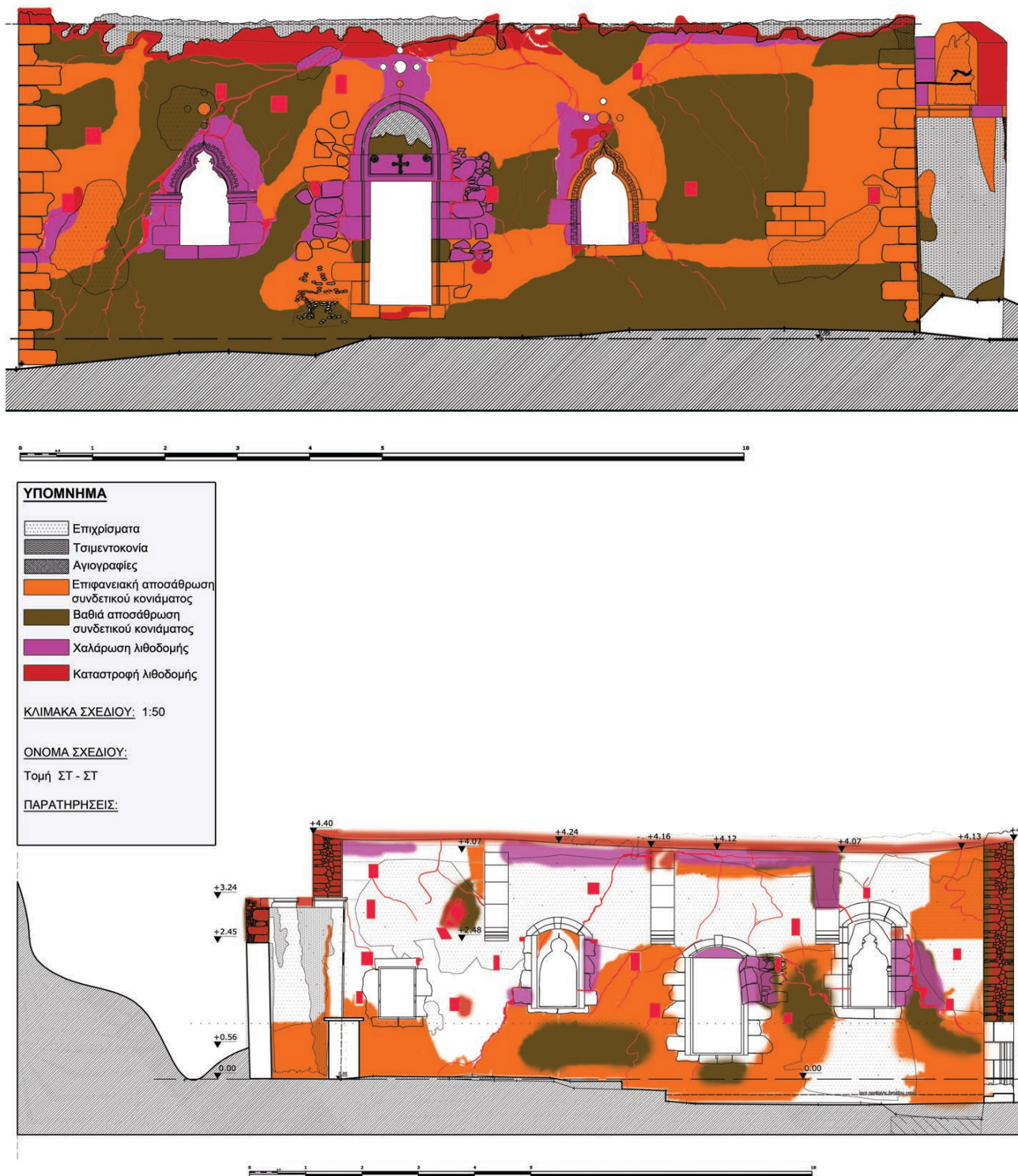
ΕΙΚΟΝΑ 118. Νότια όψη και κατά μήκος τομή του νοτιου κλίτους όπου απεικονίζεται με διαφορετικές χρωματικές διαβαθμίσεις η κατάσταση διατήρησης της λιθοδομής και των κονιαμάτων που παρουσιάζει ο νότιος τοίχος του Αγ Αντωνίου.
