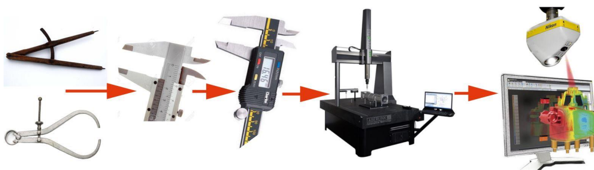
Σχήμα 2.1: Εξέλιξη μετρολογικού εξοπλισμού από αρχαία παχύμετρα σε σύγχρονες μηχανές CMM και 3D σαρωτές
