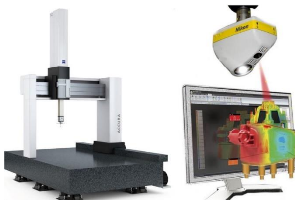
Σχήμα 2.3: Κατηγορίες CMM (Στα αριστερά παρουσιάζεται μηχανή μέτρησης συντεταγμένων επαφής ενώ στα δεξιά είναι μη-επαφής με laser-scanning)
