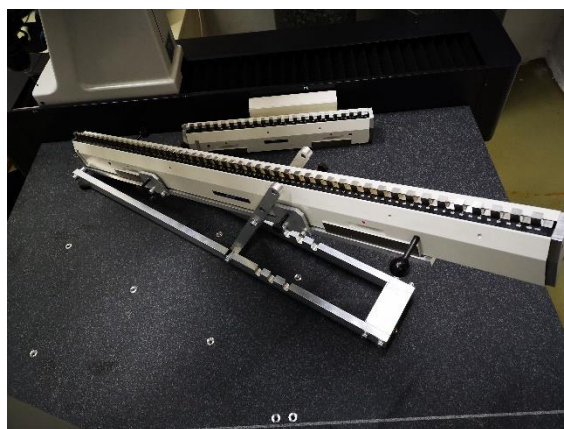
Σχήμα 3.4: Ευθυγράμμιση και διακρίβωση της CMM μετά τη τελική τοποθέτηση
