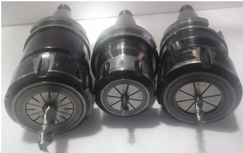
Σχήμα 4.15: Κοπτικά εργαλεία που χρησιμοποιήθηκαν για τη κατεργασία της δεύτερης φάσης του δοκιμίου
