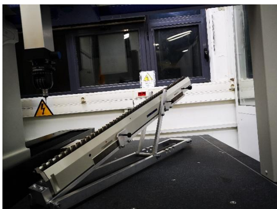
Σχήμα 3.4: Ευθυγράμμιση και διακρίβωση της CMM μετά τη τελική τοποθέτηση
