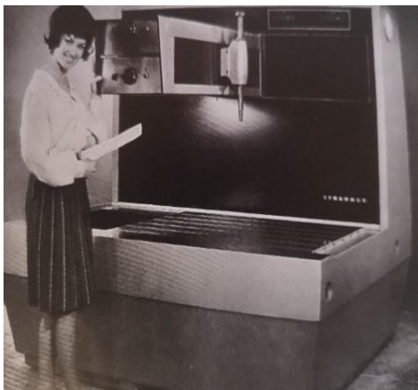
Σχήμα 2.2: Πρώτη συσκευή μέτρησης συντεταγμένων στο κόσμο της εταιρείας Ferranti
