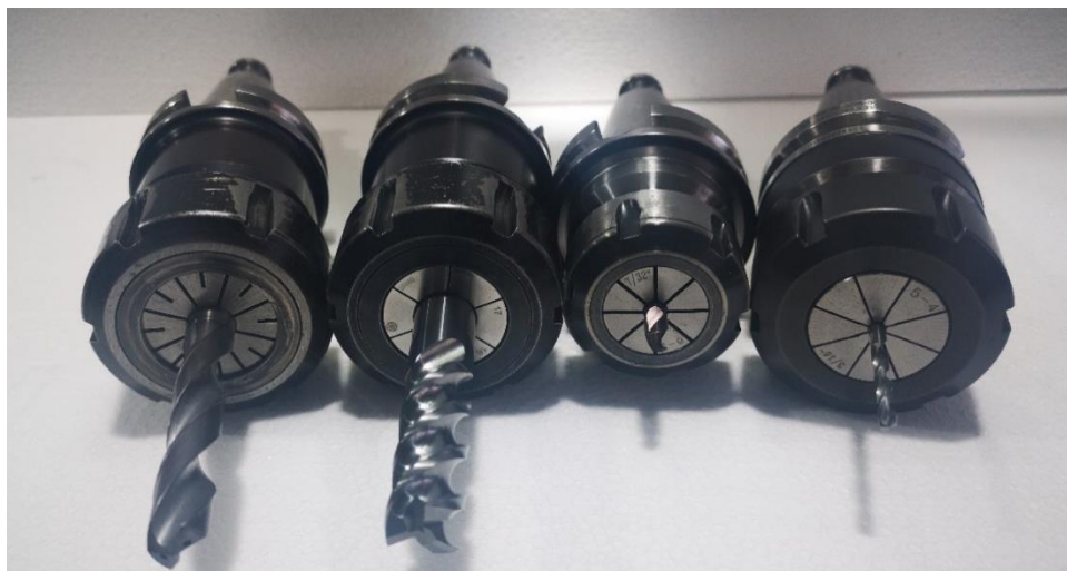
Σχήμα 4.11: Κοπτικά εργαλεία που χρησιμοποιήθηκαν για τη κατεργασία της πρώτης φάσης του δοκιμίου
