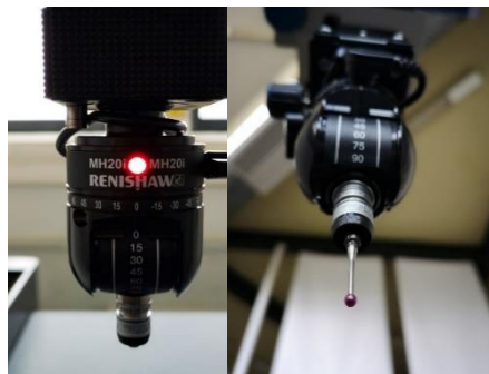
Σχήμα 3.6 : Σύστημα ανίχνευσης και ακίδα της CMM του εργαστηρίου M3
