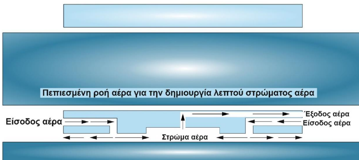
Σχήμα 3.7: Έδρανο κύλισης αέρος και σχηματική αναπαράστασή του
