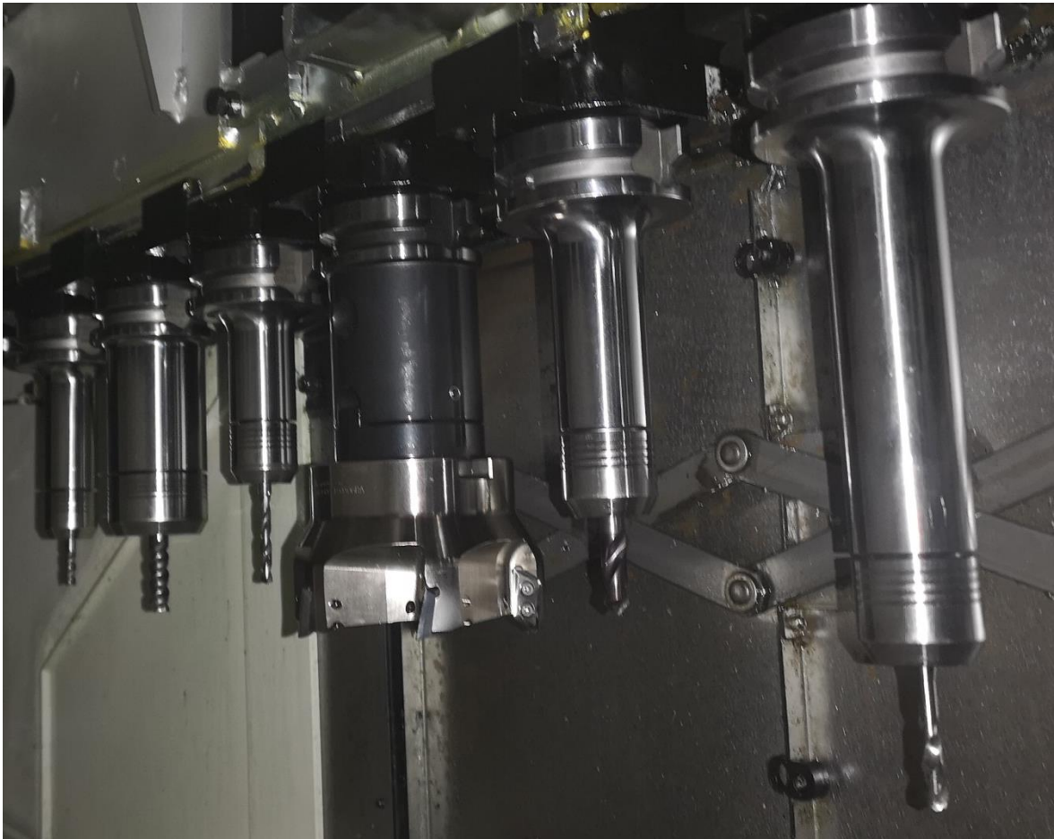
Σχήμα 4.7: Κοπτικά εργαλεία που χρησιμοποιήθηκαν για τη κατεργασία της πλάκας συγκράτησης
