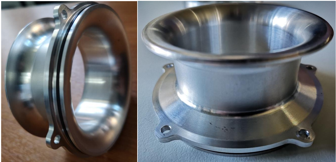
Σχήμα 5.23: Παρουσίαση της κατασκευής του δεύτερου μηχανικού μέρους έπειτα από την αντίστροφη μηχανική του πρωτοτύπου
