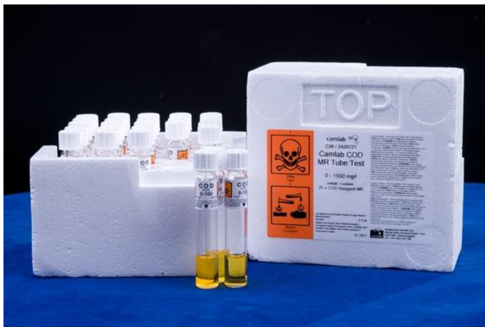
Εικόνα 3.7 : Κυψελίδες που χρησιμοποιήθηκαν για την μέτρηση του COD. Η διαδικασία που ακολουθήθηκε για τον προσδιορισμό του COD είναι η εξής:
