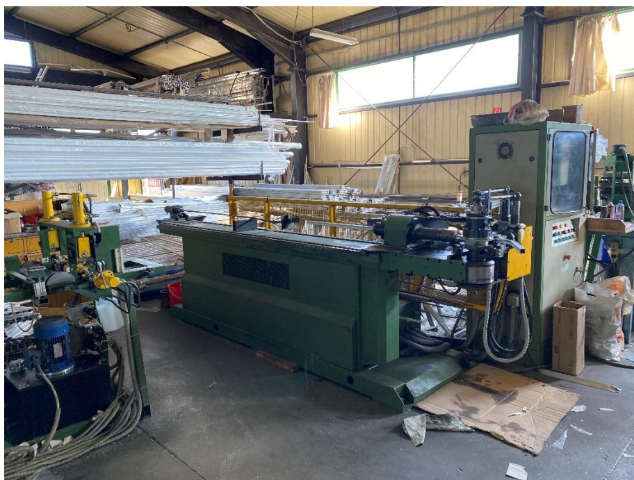
Εικόνα 22: Μηχανή κουρμπάριατος ράβδων αλουμινίου.
