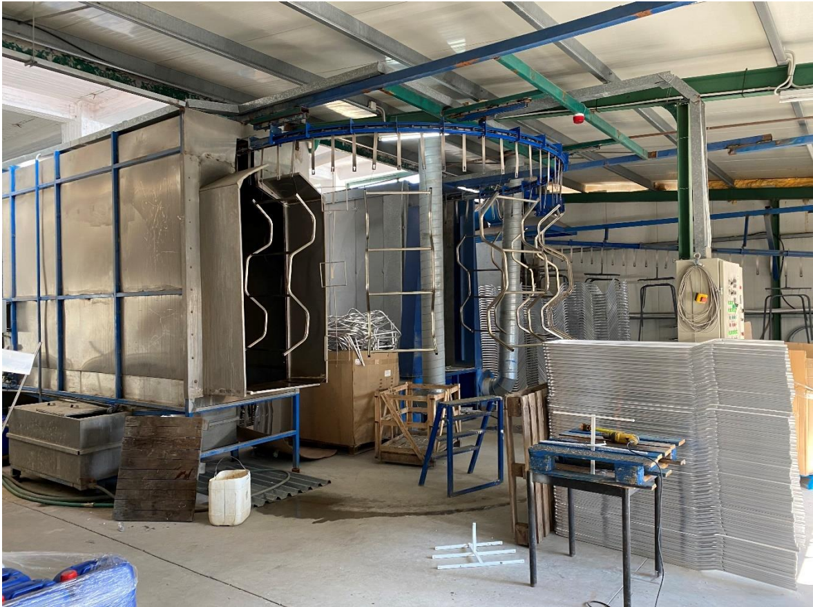
Εικόνα 29: Φούρνος βαφής μεταλλικών σκελετών της ξαπλώστρας ΣΑΝΤΟΡΙΝΗ.
