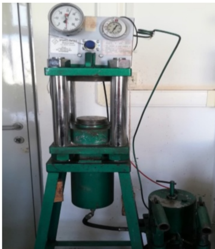
Εικόνα 8 : Εργαστηριακή υδραυλική πρέσα συμπίεσης.
