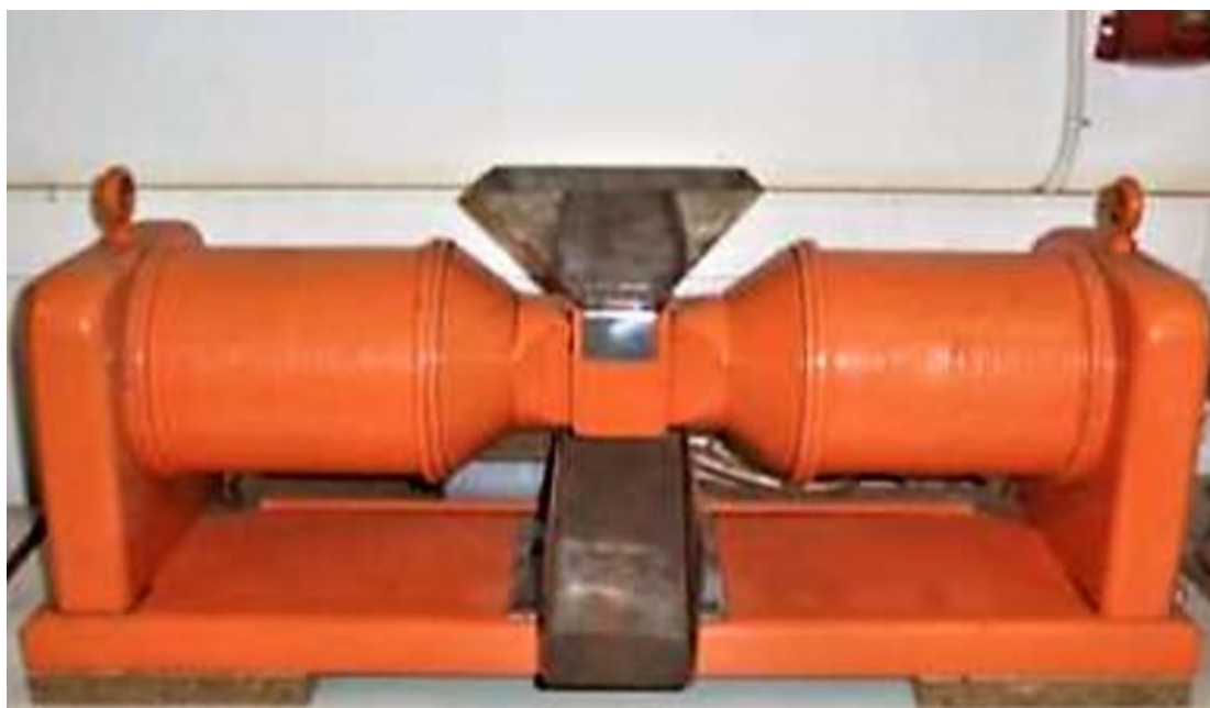
Εικόνα 7 : Υγρός μαγνητικός διαχωριστής υψηλής κλίσης πεδίου, του Εργαστηρίου Εμπλουτισμού του Πολυτεχνείου Κρήτης.
