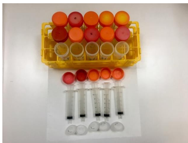
Εικόνα 7: Εξοπλισμός Πειραμάτων της Προσρόφησης (φιαλίδια Falcon, σύριγγες και φίλτρα σύριγγας 0,45 \mu\text{m} )
