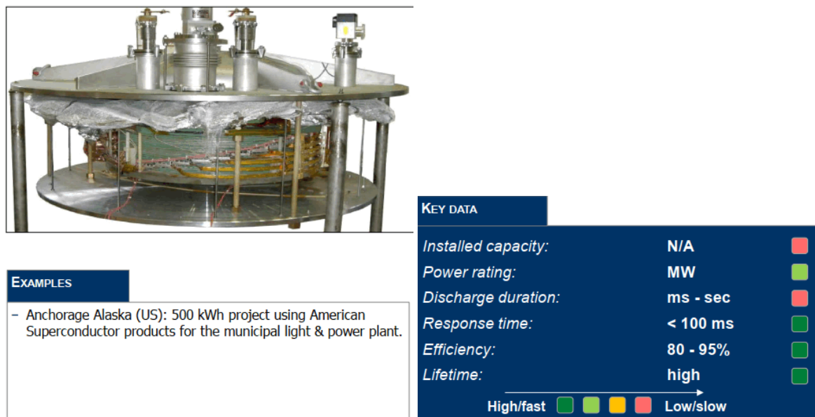
Εικόνα 161: Παράδειγμα εφαρμογής ενός συστήματος SMES. Πηγή: [23].
