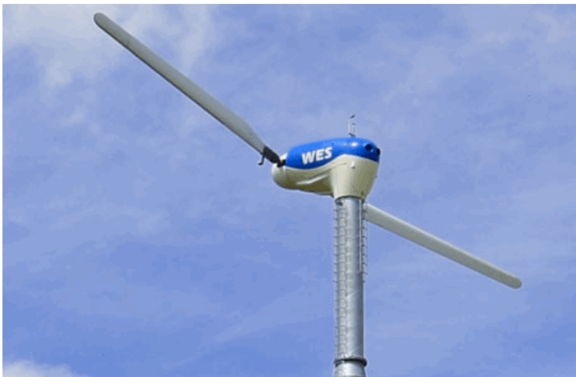
Εικόνα 67: Η Ανεμογεννήτρια που επιλέξαμε για το σενάριό μας: Μοντέλο WES 18 των 80kW: Cut in wind speed <3m/s, Cut out wind speed 25m/s, rated wind speed 13m/s, διαθέτει IGBT converter AC/DC variable frequency drive, διάμετρο 17,9m, ασύγχρονη τετραπολική, 230/400V, 400kg, ύψος πύργου 31m. Χαρακτηριστικά κατασκευαστή.
