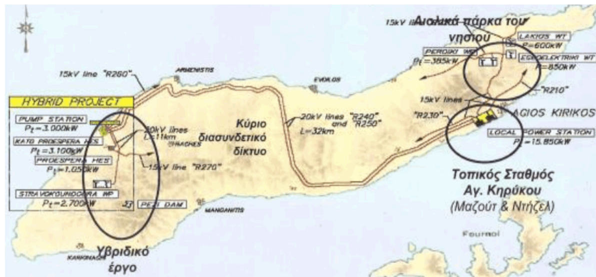
Εικόνα 41: Ο υβριδικός σταθμός βρίσκεται βορειοδυτικά στο νησί. Ανατολικά βρίσκονται και οι ανεμογεννήτριες των δύο αιολικών πάρκων, στην τοποθεσία «Περδίκι», βόρεια του Τ.Σ.Π. Τα αιολικά πάρκα (Α/Π) έχουν συνολική εγκατεστημένη ισχύ 985kW και αποτελούνται από: Μια ανεμογεννήτρια σύγχρονη των 600kW (ιδιοκτησία «Λάκιος») και επτά ασύγχρονες ανεμογεννήτριες των 55kW, συνολικής ισχύος 7×55=385kW. Πηγή: [33].
