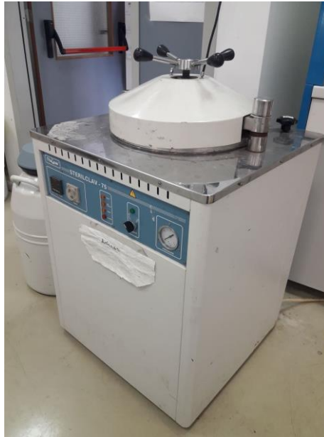
Εικόνα 17: Αυτόκαυστος κλίβανος αποστείρωσης.
