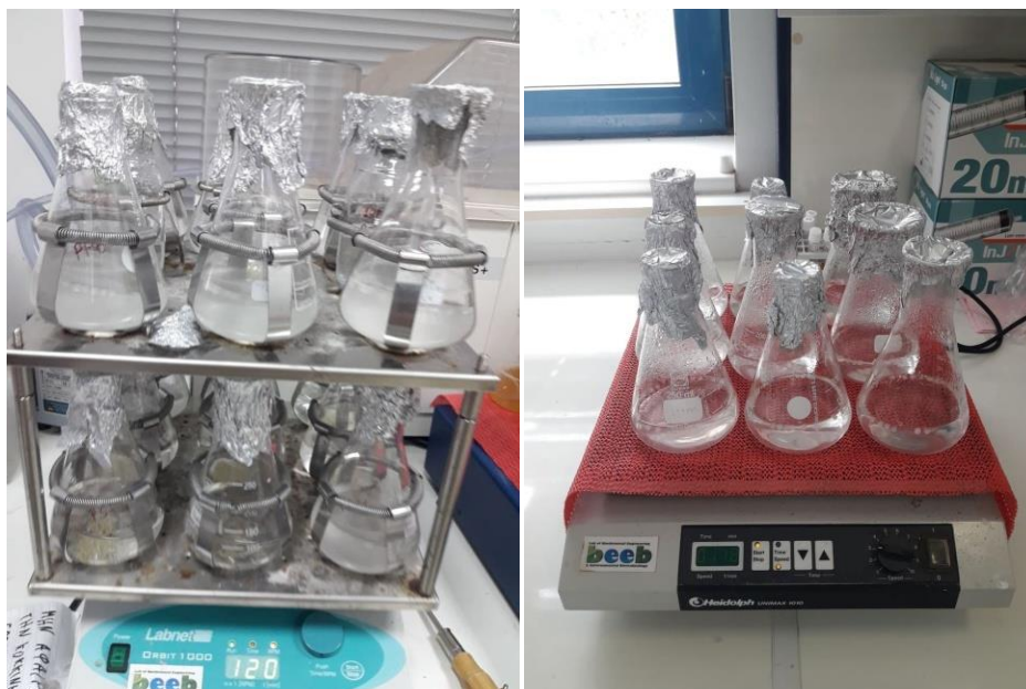
Εικόνα 20: Κωνικές φιάσκες σε τράπεζα ανάδευσης με αποστειρωμένο θαλασσινό νερό και pellets.
