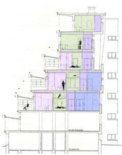
2.22 Sanatorium Guébriant, Passy Βαθμιδωτή τομή και ελεγχόμενος ηλιασμός
