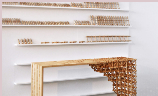
Εικόνα 89: Στάδια επεξεργασίας των στοιχείων του Mashrabiya, Mischer' traxler studio
