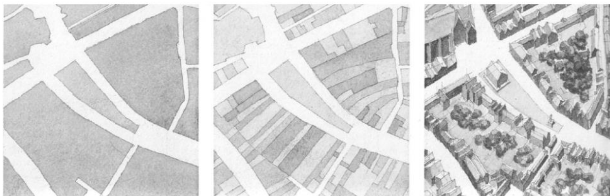
Εικόνα 86: Τα βασικά συστατικά ενός σχεδίου πόλης που προσδιορίζονται από τον αστικό γεωγράφο M.R.G. Conzen είναι: το ρυμοτομικό σχέδιο ή το σχέδιο των δρόμων (αριστερά), το σχέδιο χρήσεων γης (κέντρο) και ο τριδιάστατος οικοδομικός ιστός της πόλης (δεξιά) (Πηγή: Spiro Costof, The City Shaped, Urban Patterns and Meanings through History , Thames and Hudson Ltd, United Kingdom, 1991, σελ. 26)
